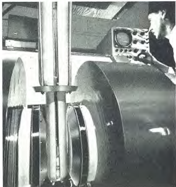
電磁石磁極間の液体ヘリウム魔法ビンにはいった二準位固体メーザで超高周波増巾の実験をしているところ
