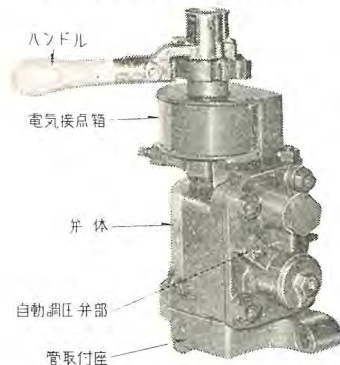
図 4.6 SA-2E 形ブレーキ弁 Fig. 4.6 Type SA-2E brake valve. 7 のようになりブレー
