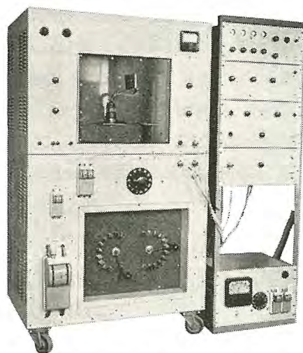
図 2.25 半導体整流体過負荷試験装置
