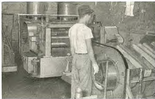
図 2.1 ケイ素鋼帯巾切り用ギャング・スリッタ Fig. 2.1 Gang splitter for the cutting of the width of silicon steel strip.
