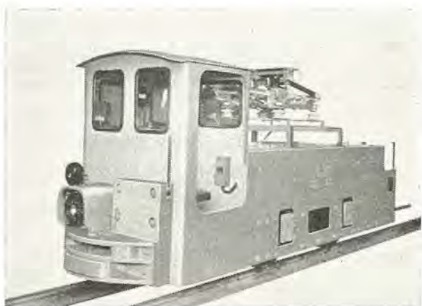
三菱鉱業納 8 t 鉱山用電気機関車 8 t Mine electric locomotive for Mitsubishi Kogyo.
