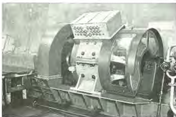
160 kW 230/115 V 520 rpm 三線式船用直流発電機 3 Wire system DC generator for marine use.
