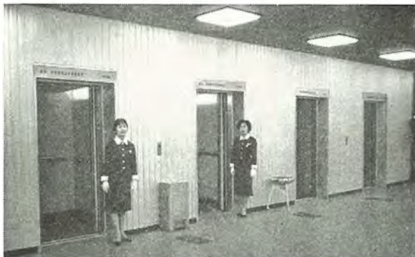
新朝日ビルギヤレスエレベータ 1 階乗場 4 台バンク 1,100 kg 150 m/min Entrance for gearless elevator.
