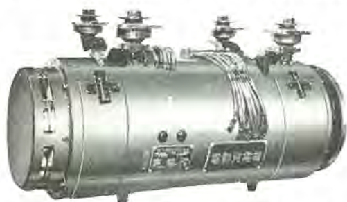
定格 電動機 直流 8.0 km (入力) 600 V 2P 発電機 交流 5.0 kVA 110 V 60 c/s 3φ 4 線式 2P 3,600 rpm
