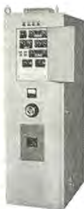
三相低周波形 プロジェクション 溶接機用タイマ Timer panel for 3 phase welder.
