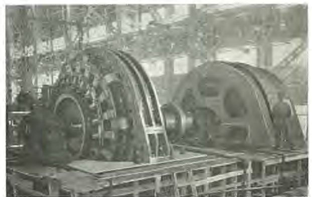
試験中の 3,360 kW 直流電動機 3,360 kW DC mill motor under test.
