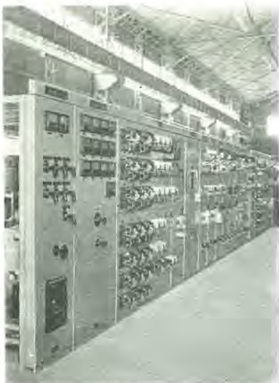
コイル準備装置用制御盤 Control panel for coil preparation line.
