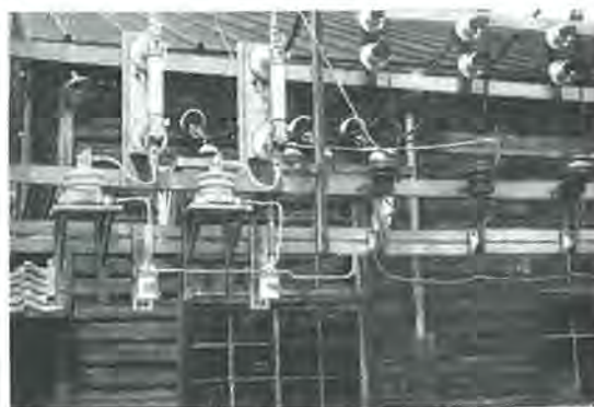
国鉄高崎変電所に取付けて試験中の PR 形アレスタ Type PR arrester under test at National Railways' substation.
