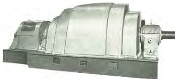
神戸製鋼経山富士製鉄納 3,500kW 3,300V 1,800rpm 60c/s 4P ターボ圧縮機用誘導電動機 3,500kW induction motor for turbo-compressor.
