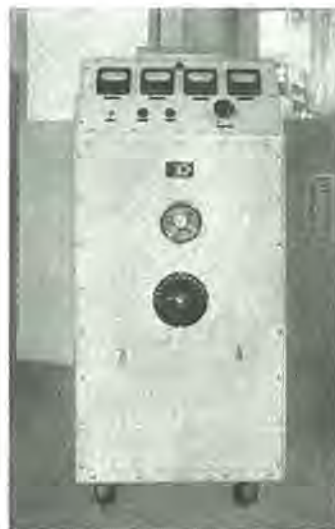
180 V 100 A ゲルマニウム整流器 (阪大工学部納) 180 V 100 A water cooled germanium rectifier.
