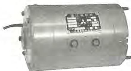
エレベータ戸閉機械用直流電動機 50 W 120 V 900 rpm 他励連続定格 DC motor for elevator door closing device.
