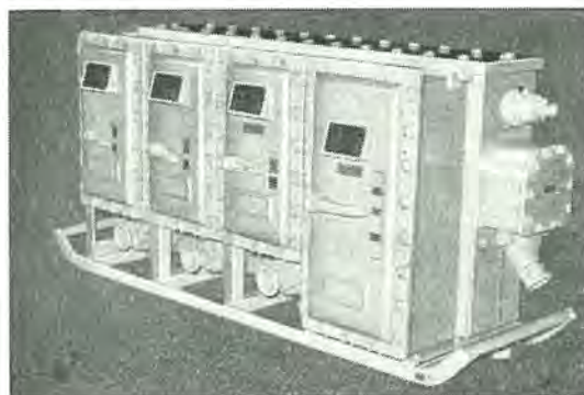
CC×0604D 形集団切羽開閉器 太平洋炭鉱釧路鉱業所納 Group working face switch.
