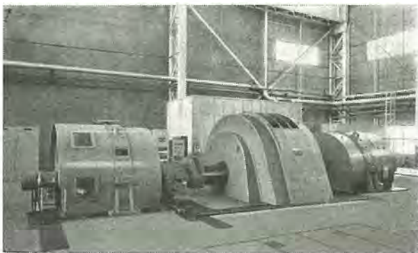
川崎製鉄千葉製鉄所納タンデムミル用電源電動発電機 Motor generator for DC power source.
