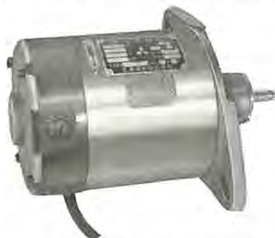
エレベータ戸閉機械用直流電動機 170 W 125 V 800 rpm 他励 1 時間定格 DC motor for elevator door closing device.
