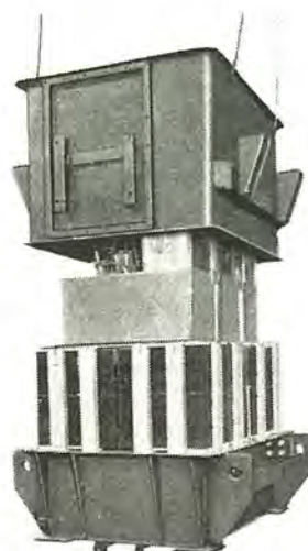
住友金属組立中の 7,500 kVA 22 kV/280～104 V 三相 60 c/s 送油風冷式アーク炉用変圧器 Arc furnace transformer.
