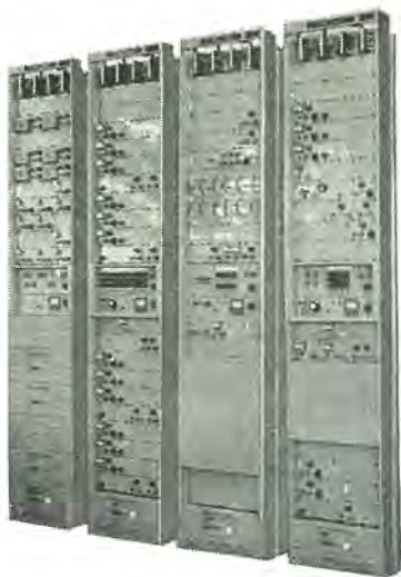
本郷局端局装置 (容量 48 Ch, 実装 18 Ch) 2,500 Mc SS-FM multiplex terminal equipment (48 channels).
