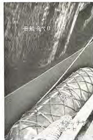
母船と 150 t キャッチャボートの接舷時における防舷物 Fender to be used for a mother ship when receiving a 150 ton catcher boat.
