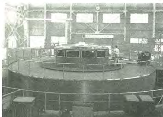
田子倉発電所向 105,000 kVA 水車発電機 105,000 kVA Water wheel generator for Tagokura Power Station.
