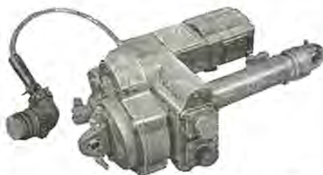
F86F 用ウイングフラップアクチュエータ 26 V 1,005 lb (平均) Wing flap actuator for F-86F jet fighter.
