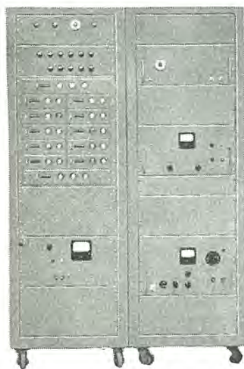
速中性子スペクトロメータおよび10チャネル波高分析器 (ND-5411) Fast neutron spectrometer and 10 channel pulse height analyzer.
