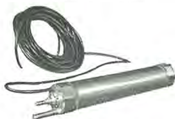
深井戸ポンプ用 水封式水中電動機 11 kW 200 V 3,600 rpm 60 c/s 二極 11 kW submerged type well motor.
