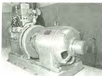
足利銀行納自励交流発電機 15 kVA 220V 1,000 rpm 50 c/s 3 \phi 6P 0.8 PF 連続定格 Self-excited AC generator.
