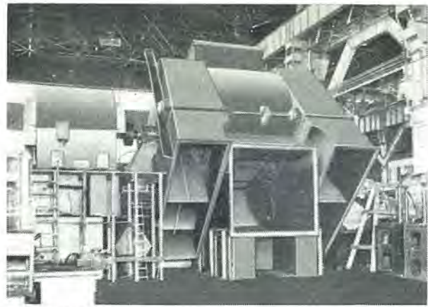
関西電力姫路発電所納 ID-1012 両吸込ターボファン 風量 8,000 m 3 /min 風圧 370 mm Aq 回転数 592 rpm 電動機 800 kW Double inlet turbobvane fan.
