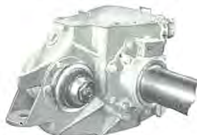
近鉄「ビスタ・カー」WN-50-C 3 形ギヤユニット 歯車比 79/18 (モジュール=7, よじれ角=21 度) Type WN-50-C 3 gear unit.
