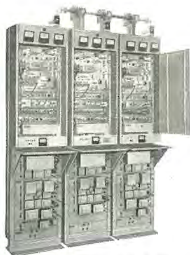
(左および右) 現用機 (中央) 予備機 7,500 Mc 帯 SS-FM 送受信機 (出水局) 7,500 Mc-SS-FM multiple radio equipment
