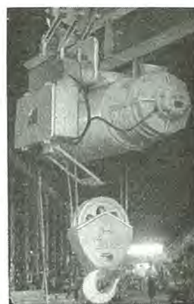
HB-5HM 形電気ホイス 5 t 電動走行形 高揚程 5 ton motor hoist.
