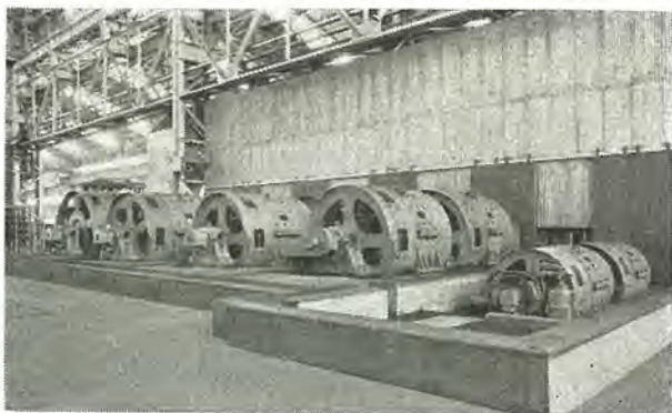
川崎製鉄千葉製鉄所納タンデムミル電動機 DC mill motors for cold tandem mill.
