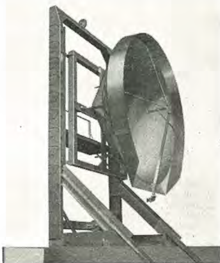
4,000 Mc パラボラアンテナ (改良形) 4,000 Mc parabola antenna (modification).
