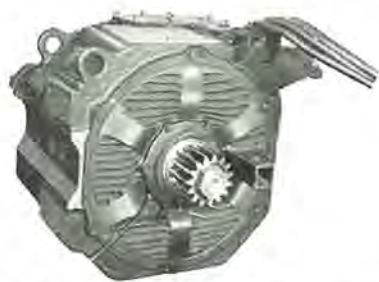
国鉄 ED60 直流電機用 MT-49 形主電動機 (1 時間 400 kW 750 V 575 A 1,180 rpm)
