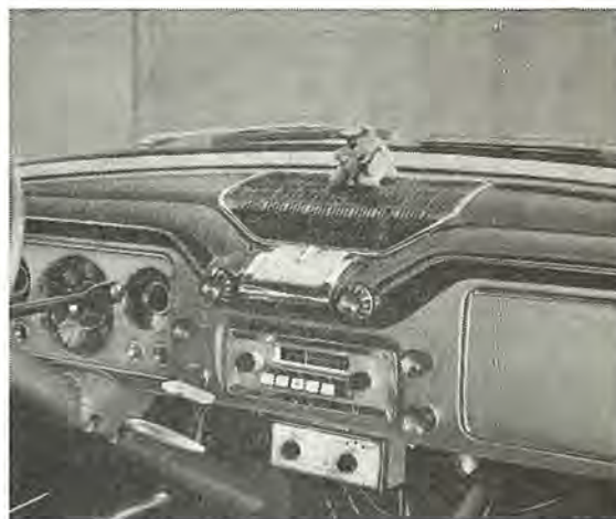
AR-210 形オートラジオおよび AT-320 形短波チューナ車体取付けの一例
