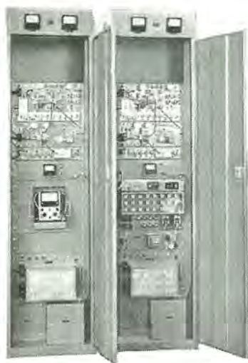
(左) 現用機 (右) 予備機 2,500 Mc 帯 SS-FM 送受信機 2,500 Mc SS-FM multiple radio equipment.
