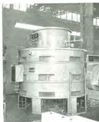
九州電力納循環水ポンプ用電動機 MKEV-V 550 kW 3,300 V 60 c/s 20P
