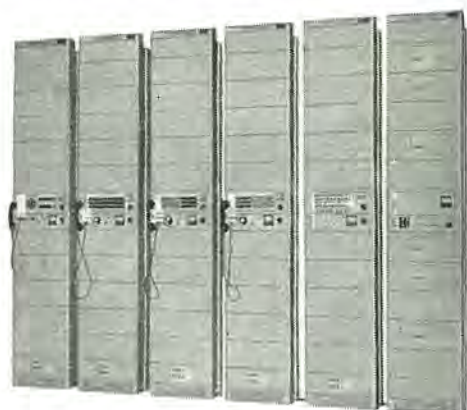
鹿児島局端局装置 7,500 Mc SS-FM multiplex terminal equipment.
