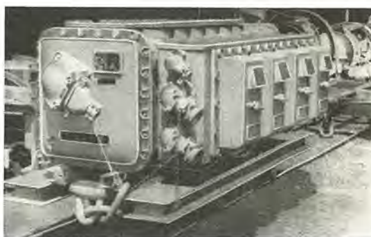
150 kVA マインパワーセンタ (台車付) Mine power center on a truck.
