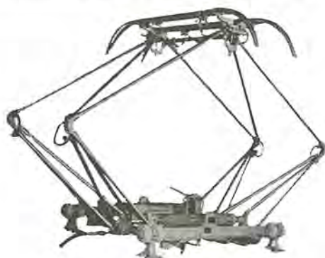
S-756-AC 形パンタグラフ (折りたたみ緩衝用オイルダンパ付) Type S-756-AC pantograph with oil-dampers for cushion in lowering.
