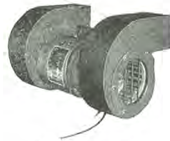
ARC-27 用外部送風機 27.5 V 4 m 3 /min 10,000 rpm External fan for ARC-27.
