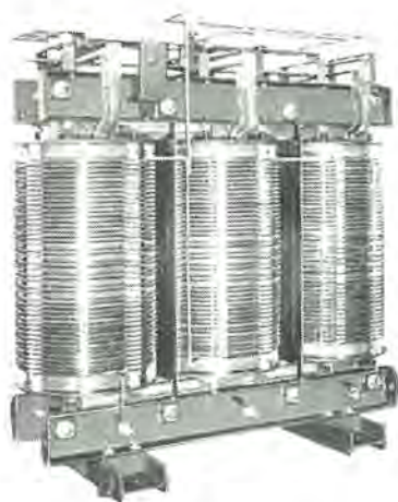
関西電力納 1,000 kVA 3.3 kV/480 V 三相 60 c/s 自冷式 H 種絶縁乾式変圧器 Class H insulation dry type transformer.
