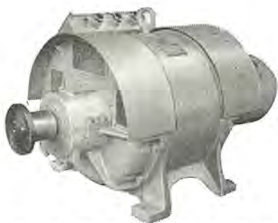
三菱造船（下関）納 DA 形交流発電機（補助） 50 kVA 450 V 720 rpm 60 c/s 3 φ PF 0.8（閉鎖防滴形） Type DA AC generator (for auxiliary use).
