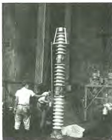
SV-W 2 A 形 70 kV 避雷器の汚損試験状況 Soiling testing type SV-W 2 A 70 kV lightning arrester.
