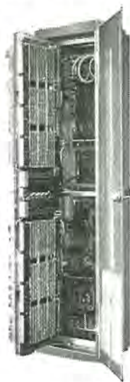
パラメトロンを使用した ARQ 端局装置 (背面) Parametric time division multiplex ARQ terminal equipment (behind view)
