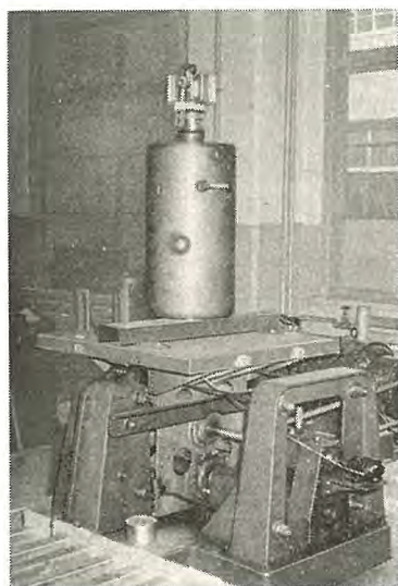
図 4.14 GU-31 形整流タンク振動試験状況 Fig. 4.14 Type GU-31 rectifier tank vibration test state.
