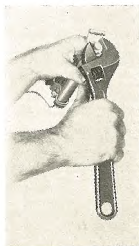
(c) フック金具にキャップをねじ込む
