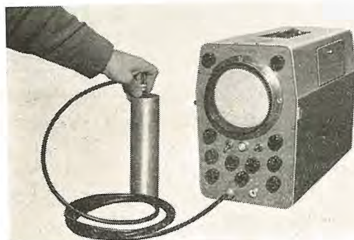
図 4.3 学振 I 形試験片の探傷状況
