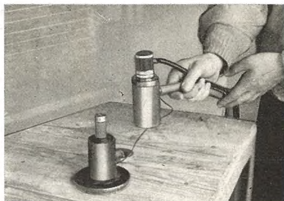
(a) 簡易水浸法の探触子アタッチメントおよび治具を示す
