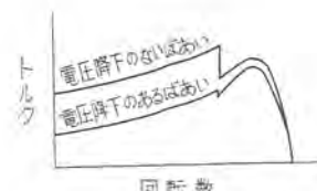
図 3.13 分相起動形単相モートルにおける電圧降下とトルク特性 Fig. 3.13 Voltage drop and torque characteristic of split start phase start single phase motor.
