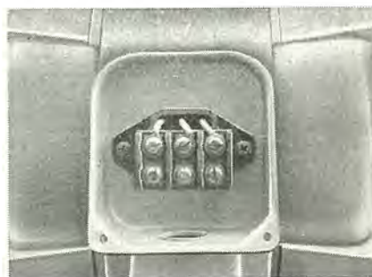
図 5.8 1,300 フレーム以下の端子箱内部 Fig. 5.8 Interior of terminal box for frames below 1,300.
