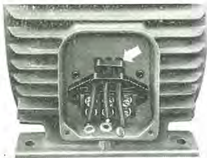
図 5.10 1,300 フレーム以下 SF-A 形の口出線引出部 Fig. 5.10 Lead wire of type SF-A motor.
