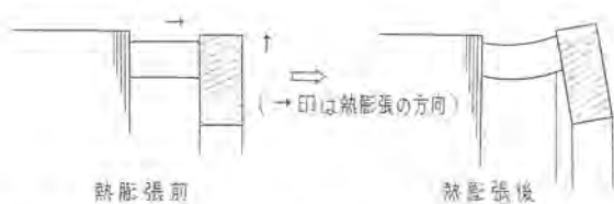
図 2.1 回転子バー、エンドリングの熱膨張にともなう変形 Fig. 2.1 Deformation of rotor bars and endrings due to thermal expansion.
