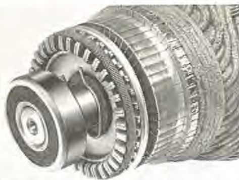
図 4.3 SI-A形750W4Pにおける寿命試験後の整流子・短絡環接触面の荒れはほとんど見られない Fig. 4.3 Commutator after life test of type SI-A 750 W motor.
