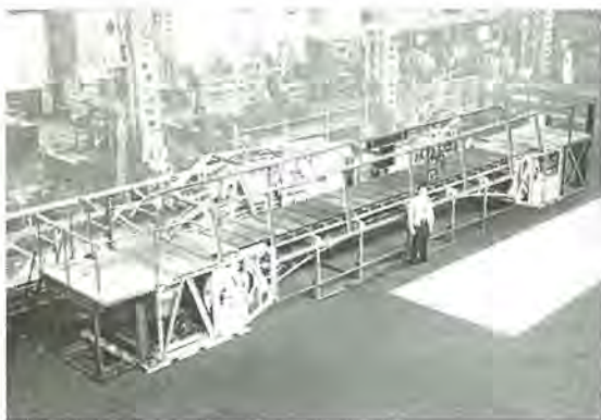
図 1.1 三菱トラベータの全景である。写真で白く見えているトラスが付属部分で灰色に見える部分はすえ付、運転のためにとくに設けた支持台である。通常、踏板面は床面の高さとなる。
