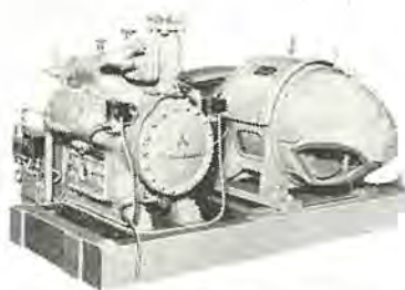
図 5.7 MC-8B-F 形 40 馬力圧縮ユニット外観
