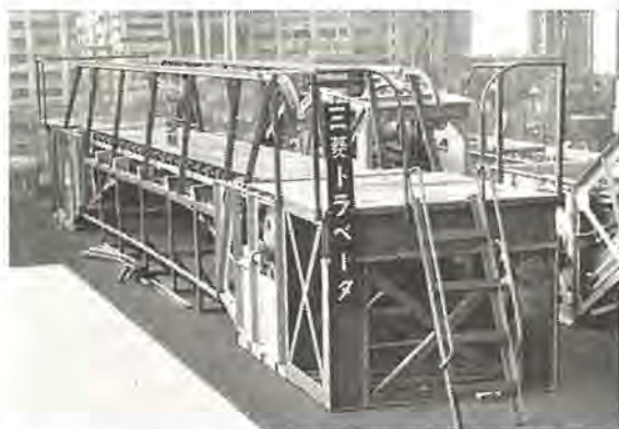
図 3.1 遊び側乗り口を示す。手前のはしごおよび灰色のトラスは床面の一部としてとくに設けた試験用おどり場である。
