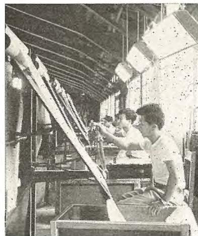
図 7.3 検査用蛍光灯照明器具による輪転検査 Fig 7.3 Rotating test with a fluorescent lighting fixtures for the test use.
