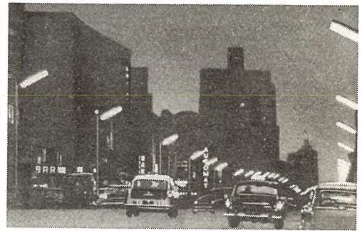
図 42 ニューヨーク・マンハッタン 3 番通りの高出力形蛍光灯による街路照明
