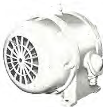
図 3.3 帝国化工納 100 HP 3,300 V 60 c/s 6 P 1,200 rpm レイモンドミル、ファン用防食電動機
