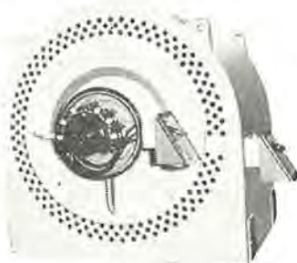
図 4.1 帝国化工納 250HP 3,300 V 60 c/s 16 P 450 rpm レイモンドミル用外扇形防食電動機(銅冷却管採用)
