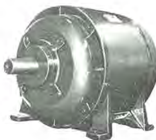
図 3.9 モンサント化成納入 ナッシュポンプ用防食電 動機 30 kW 220V 60c/s 8 P 875 rpm. (有機ガ ラス名板使用)
