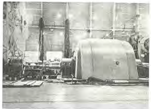
図 1.2 台湾電力龍洞発電所へ納入した 54,000 kVA 水車発電機の工場試験
