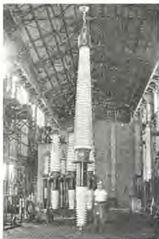
耐塩害用絶縁階級 200 号 OT 形油入密封式コンデンサブッシング
