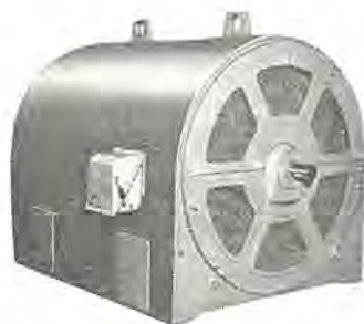
図 4.2 東海硫安納 400 kW 3,300 V 60 c/s 2P 3,600 rpm. ブロワ用外扇形防食電動機(銅冷却管使用) Fig. 4.2 External fan type corrosionproof motor for blower.
