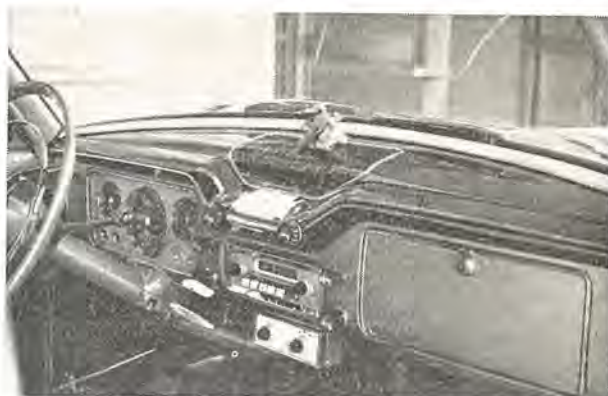
図 9.10 AR-210 形 オートラジオと AT-320 形短波チューナの取付の一例 Fig. 9.10 Example of mounting type AR-210 auto-radio and type AT-320 short-wave tuner.
