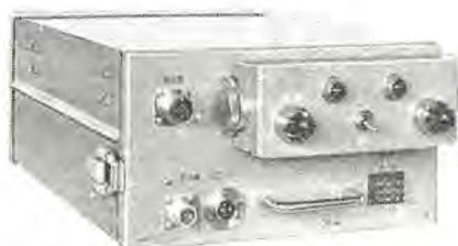
図 3.4 FM-6 形 移動用無線機 (5 W)
