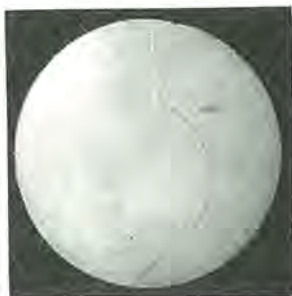
図 5.13 曲げられた針状結晶 Fig. 5.13 Elastically bended whisker.
