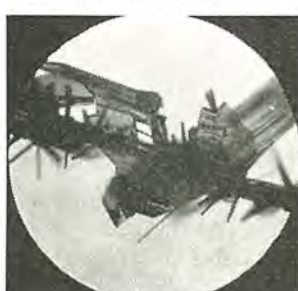
図 4.7 樹状結晶 Fig. 4.7. Dendritic crystals.
