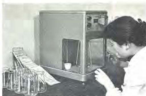
図 3.1 試料の秤量 (メトラ直示天秤による)
