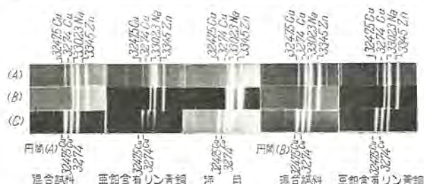
図 5.1 混合試料、亜鉛含有リン青銅、洋白のスペクトル
