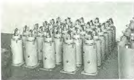
今回初めて使用した12 インチ級の液冷式密封形 イグナイトロン整流タンク製作状況 この整流タンクはつぎの定格を有している ① 平均電流=400 A/1 タンク ② 二重格子構造で許容先頭遮断電圧値は 5,500 V ③ 陽極先頭電流は 20,000 A
