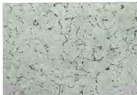
図 3.12 フェライト相から転化したシグマ相、試験片 (K-1, 4 mmφ) × 500, 10%NaCN 電解 Fig. 3.12 Sigma-phase precipitated from ferrite phase in weld metal, specimen C (K-1, 4 mmφ) × 500, Etchant: 10%NaCN electrolytic.
