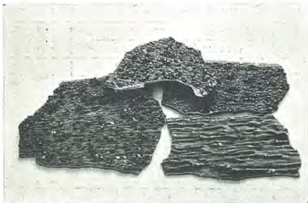
図 4.5 電解クロム (厚さ 3~4 mm)
