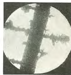
図 4.11 帯状結晶からの突出 Fig. 4.11. Branch from lamellar crystal.
