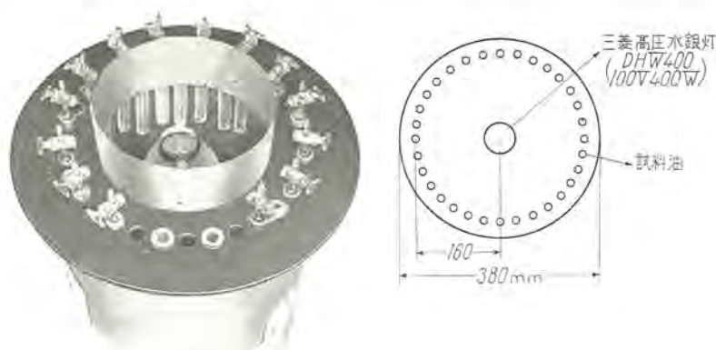
図 2.2 紫外線照射による油の試験装置
