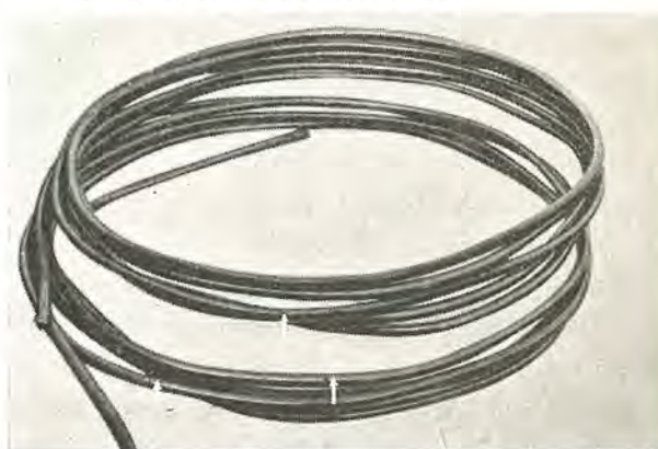
図 4.4 第2回試作再溶解品の熱間圧延線材の圧延われを示す。矢印の部分 (直径13 mmφ)
