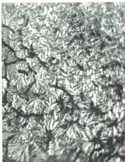
150°C 2hr. 結晶化試料を 180°C 1.5hr. 追加加熱 × 400
