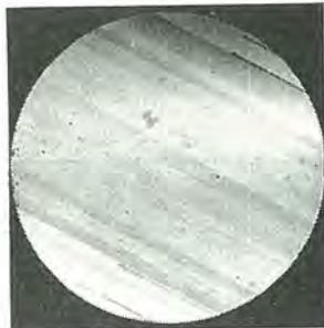
図 4.17 板状結晶中の転位 Fig. 4.17. Dislocation in the plate-like crystal.
