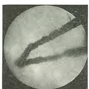
図 4.13 鐘乳状結晶 Fig. 4.13. Stalactic crystal.
