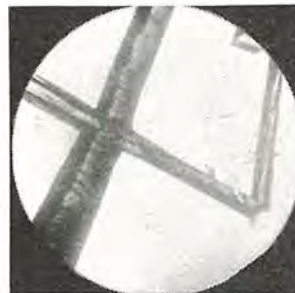
図 4.31 低温部にできる結晶 Fig. 4.31 Crystal grown at low temperature place.
