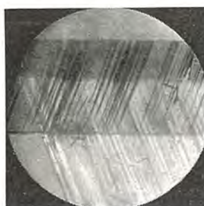
図 4.39 双晶の発生 Fig. 4.39 Growth of twin.
