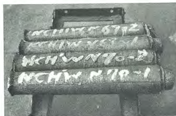
図 4.7 第3回試作品およびテルミットクロムを用いた比較品の鑄塊を示す (直径 100~128 mmφ 長さ約 625 mm)
