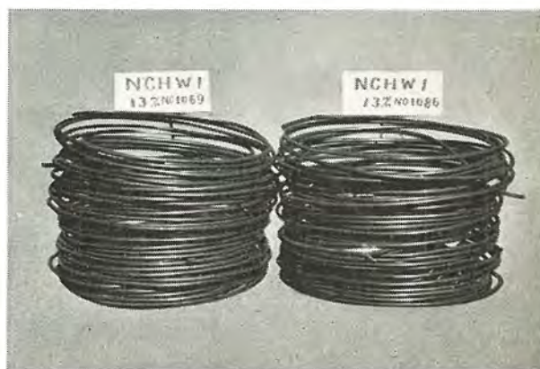
図 4.14 第3回試作再溶解品およびテルミットクロムを用いた比較品の熱間圧延線材を示す（直径 13 mm）
