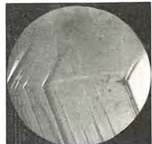
図 4.36 73 度双晶 Fig. 4.36 73° twin.
