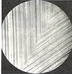
図 4.34 28 度双晶 Fig. 4.34 28° twin.
