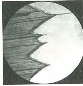
図 4.22 針状結晶の生長 Fig. 4.22. Growth of needle-like crystal.
