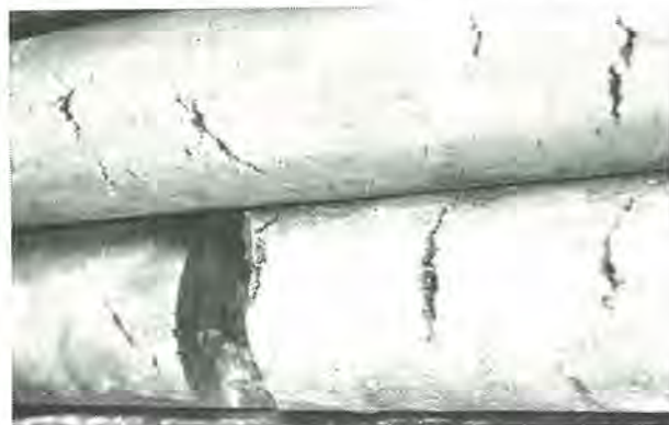
図 4.2 第2回試作品の鍛造あがりのわれを示す(直径80 mm)
