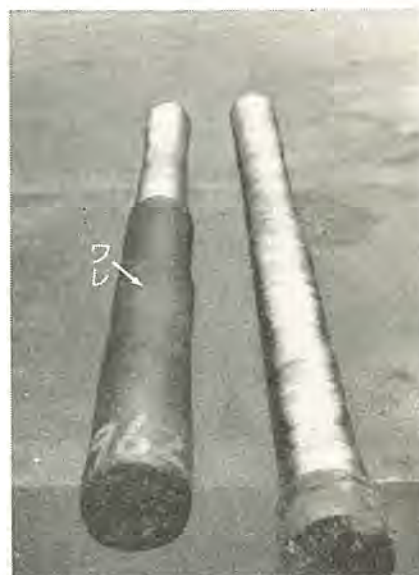
図 4.3 第2回試作再溶解品の鍛造せるものの鍛造われおよび面削状況を示す
