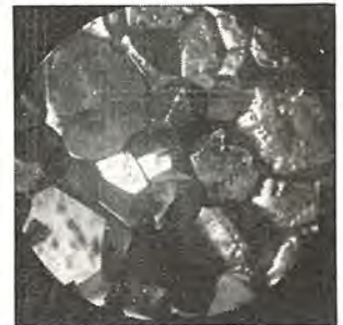
図 4.40 塊状結晶 Fig. 4.40 Block crystals.
