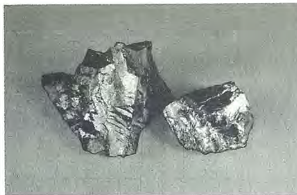
図 4.6 テルミットクロム (クロム含有量 99%以上)
