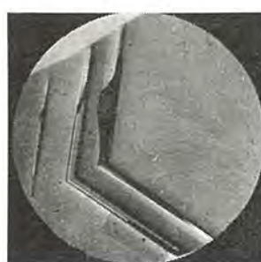
図 4.35 58 度双晶 Fig. 4.35 58° twin.
