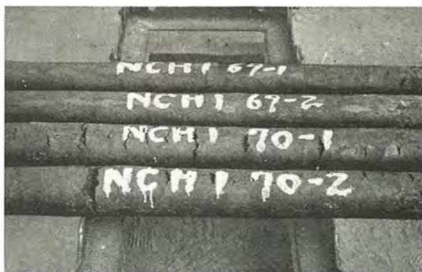
図 4.9 第3回試作品およびテルミットクロムを用いた比較品の鍛造後を示す（第3回試作品には鍛造われがみられる）
