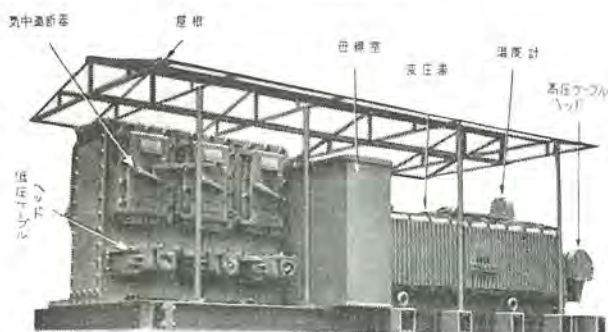
図 7.3 AS 形 H 種絶縁乾式変圧器 3φ 60~450kVA 3.3kV/220V
