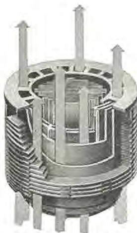
図 7.6 十分の冷却が行われる広い空隙をもったコイル Fig. 7.6 Cutaway view showing large air ducts and path of ventilating draft.
