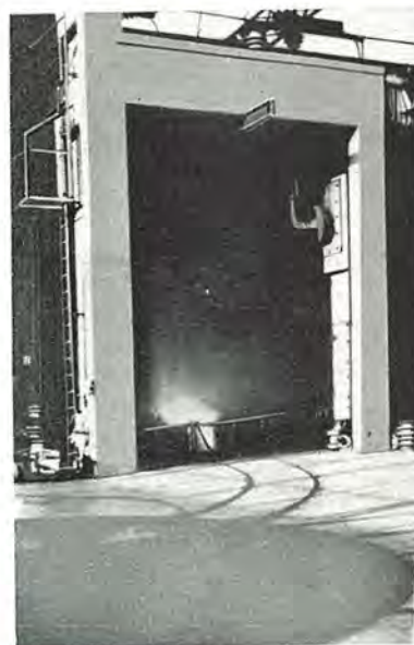
図 2 50,000 kVA 短絡発電機を使用して 回路電圧で避雷器を動作させ 10,000 A を流した場合
