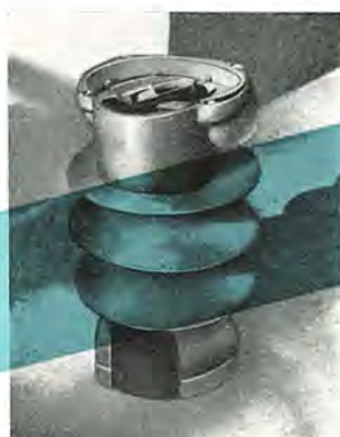
図 3 試験後の避雷器の状態 (磁器ケーシング自体は爆発飛散し ていないことを示している)
