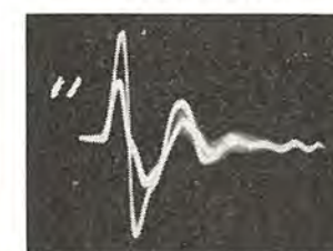
11. 10ターン短絡 タップ10 -11 間を短絡した場合 図 10 と同じ 10 ターン短絡であるが位置が相違するため多少の違いがある。
