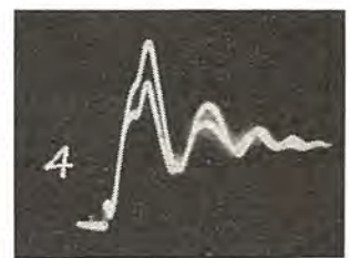
4. 20 ターン絡短 図2および3に比して2倍の短絡であるが、5, 5' 間に現われる電圧差は約 1.5 倍程度である。これより電圧差は短絡したターン数に比例しないことがわかる。
