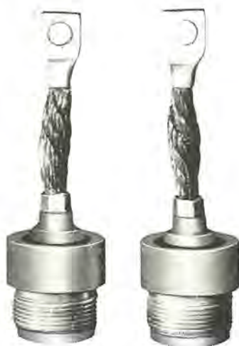
図 3.1 W社製風冷式シリコンダイオード 150A 平均電流値 P. I. V.=250V Fig. 3.1 Westinghouse air cooled silicon diode.
