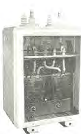
図 7.7 AV 形 H 種絶縁乾式変圧器 1φ 50 c/s 50 kVA 3.3 kV/210—105 V Fig. 7.7 Class H insulation self-cooled dry type transformer.
