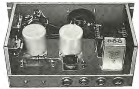
図 4.9 原子炉制御棒駆動装置用サーボ増巾器 Fig. 4.9 Servo-amplifier for driving control nod of nuclear reactor.
