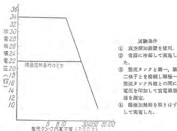
図 5.4 風冷式密封形イグナイトロン整流タンク真空度探知曲線 Fig. 5.4 Vacuum in rectifier tank.
