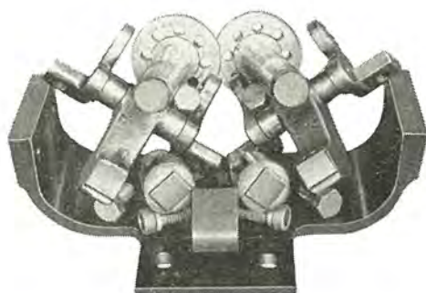
図 4.4 遮断試験後の各コンタクト Fig. 4.4 Contacts after interruption test.
