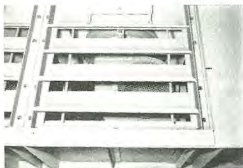
図 4.11 冷却風取入口 Fig. 4.11 Intake of cooling air.
