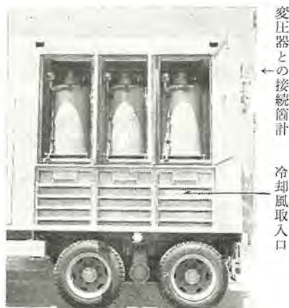
図 4.7 3,000 kW, 1,500 V, 2,000 A. 6 タンク E 種定格 風冷式 密封形 イグナイトロン 整流器 整流タンク積載状況を示す。 Fig. 4.7 Rectifier car, 3,000 kW, 1,500 V, 2,000 A air cooled sealed-off ignitron.
