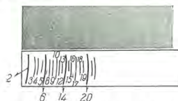
図 3.9 \alpha 単斜晶 Se (カメラ半径 100 mm, Fe 対陰極)
