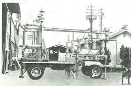
図 4.2 開閉器車（展開状態） Fig. 4.2 Switches on the car in use.
