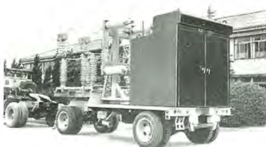
図 4.1 開閉器車（輸送状態） Fig. 4.1 Switches on the car in transit.
