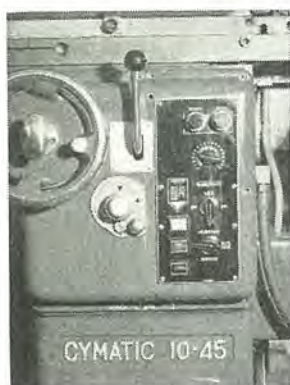
トヨタ工機注文 RA-10×45 型ジャンドルン研削盤用操作盤 Operating panel for type RA-10×45 grinder.
