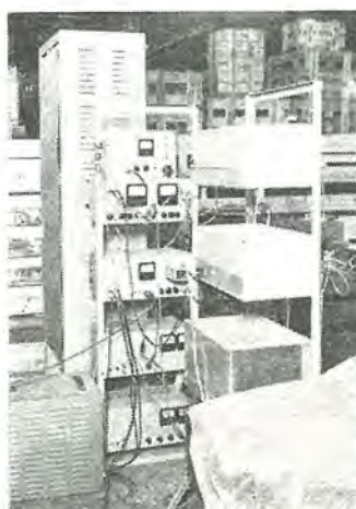
図 2. ビート方式による精密速度検出装置
