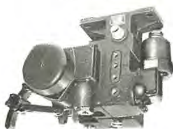
ME 38 形ブレーキ弁 ME 38 brake valve.
