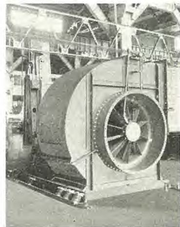
読売会館納 TV-125 片吸込ターボファン 風量 62460 CFM 風圧 4 in Aq 回転数 730 rpm 電動機 80 HP
