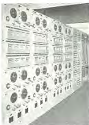
関西電力交流計算盤 発電機単位キャビネット A-C calculating panel.
