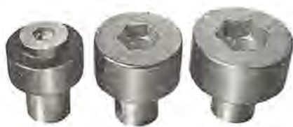
ボルト頭ヘッダを放電加工したもの Bolt head processed.
