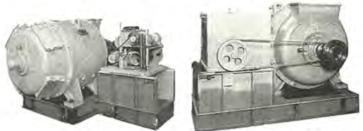
東北パルプ石巻納セクショナルドライブ 250 HP 直流電動機と差動歯車式自動速度調整器
