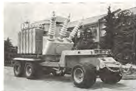
移動変圧器 三相 2,000 kVA 60 c/s 66-22/6.9-3.45kV 自冷式 Mobile transformer.
