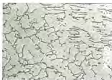
347 タイプステンレス鋼 溶着金属の顕微鏡組織 (500 倍) Microstructure of type 347 stainless steel.
