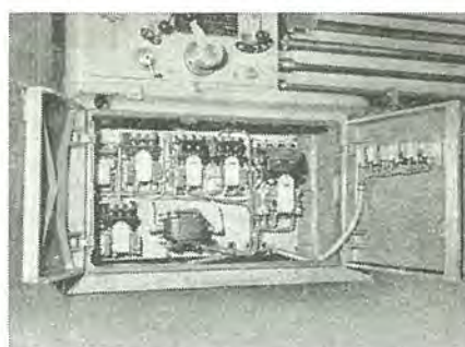
広島精機注文 DMO 型エリコン旋盤用制御盤 Control panel for type DMO lathe.
