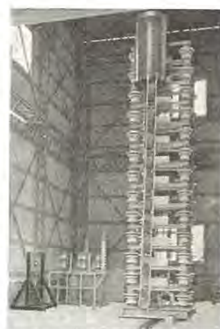
鈴木合金株式会社納 PU 型 1,200 kV 衝撃電圧発生装置 Type PU 1,200 kV surge generator.
