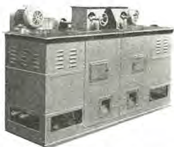
東海電機納 HM-3 型磁気選別機 Type HM-3 magnetic separator.
