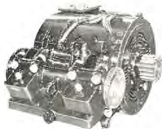
国鉄納 DF50 形電気式ジーゼル 機関車用 MT48 形主電動機 連続定格 100kW, 225V, 520A, 410rpm.
