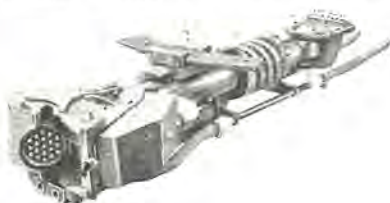
K-2-A 形密着自動連結器 K-2-A automatic tight coupler.
