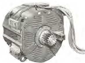
国鉄納 ED 70 形交流機関車 用 MT100 形 主電動機 連続定格 375kW, 570V, 710A, 1020rpm. 1 時間定格 400 kW, 570 V, 760A, 1,000rpm. Type MT100 traction motor.
