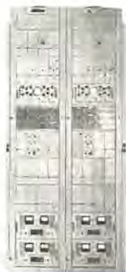
TZ-1 型 ARQ 端局装置 (2 CH 用 2 台を示す) Type TZ-1 ARQ telegraph terminal equipment.
