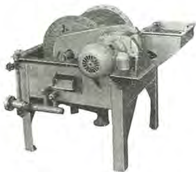
日立金属納 DA-55B 型磁気選別機 Type DA-55 B magnetic separator.
