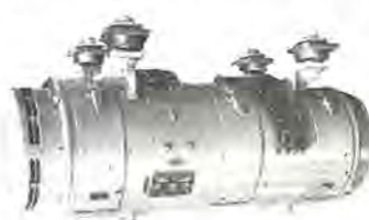
近鉄納 MG-57-S 形電動発電機 入力 7.0k W, 1,500 V, 3,600 rpm. 出力 40kVA, 100V, 3φ, 60c/s, 420kg Type MG-57-S motor generator.
