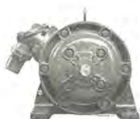
耐圧防爆形 5 HP 4 P カゴ形誘導電動機 dA1 形、B 種絶縁 厚鋼管配線用端子箱付。 Explosion-proof type 5 HP motor with a terminal box for heavy steel pipe wiring.
