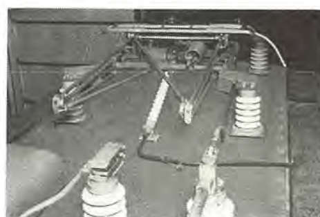
国鉄納 ED70 形交流電気機関車用 PS100A 形パンタグラフ Pantograph for the Japanese National Railways.
