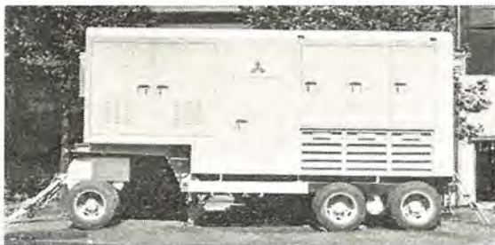
整流器車 3,000 kW 1,500 V 6 タンク風冷式、密封型 イグナイトロン整流器 Rectifier car.
