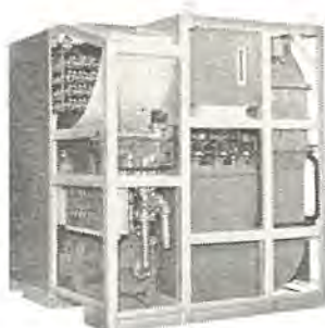
ED-70 形イグナイトロン 電気機関車用風冷式再冷却器 Air cooled recoler for ignitron locomotive.
