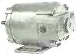
FK 形直流電動機 (IBM カード送り機械用) 1/2 HP 115 V 2,850 rpm 複巻連続使用 d-c motor for IBM card feeding.
