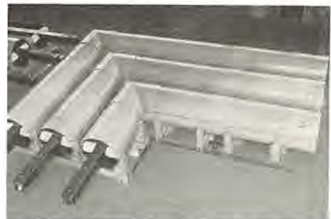
工場で組立中の離相母線 絶縁耐力 A-C 50kV 定格電流 4,000 A imp. 110kV Isolate busbar 50kV 4,000 A.
