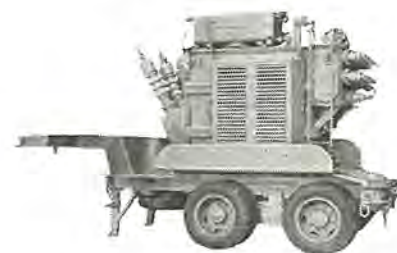
移動変圧器 三相 2,000 kVA 60 c/s 33-22/6.9-3.45 kV 送油風冷式 Mobile transformer.
