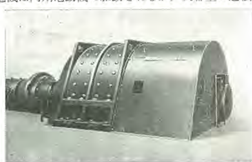
富士製鉄室蘭製鉄所熱間ストリップミル粗圧延機用 2×3,000 HP 600 V, 40/100 rpm Twin drive 主電動機 2×3,000 HP Twin drive motor for reversing rougher of strip mill.
