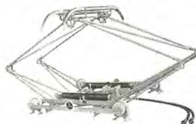
富士山麓電鉄納 S 522-A 形パンタグラフ S 522-A pantograph for Fujisanroku Railway.
