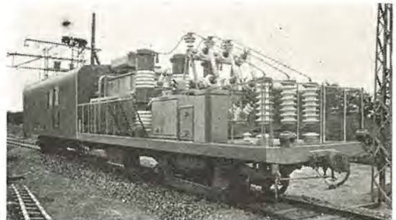
西武鉄道納 2,000 kW 1,500 V 6 タンク風冷式密封型 イグナイトロン 移動変電所 受電電圧 22 kV および 3.3 kV 両用 Mobile substation with ignitron rectifier.
