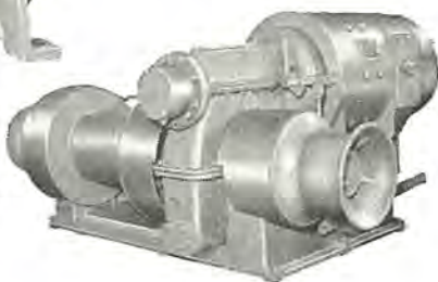
8t×90f 直流電動 揚貨機 D-C motor operated winch.
