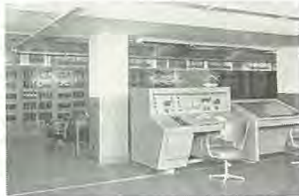
関西電力交流計算盤全景 (計測機、記録卓 および一般回路単位キャビネット) A-C calculating board.
