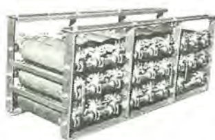
近鉄納 EW-102-39 形主抵抗器 Type EW-102-39 main resistor.
