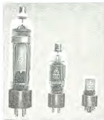
クセノン封入格子制御放電管 Grid control discharge tubes filled with xenon.
