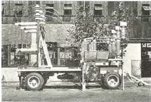
開閉器車 国鉄納 3,000 kW 1,500 V 移動変電所 Mobile switching station.
