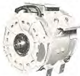
近鉄(南大阪線)納狭軌用 WN ドライブ MB-3032-S 形主電動機 1 時間定格 90kW, 375 V 270A, 1750rpm.
