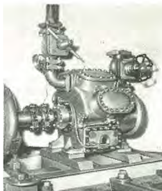
MC 型冷凍機 (空気試験中) Type MC refrigerator compressor.
