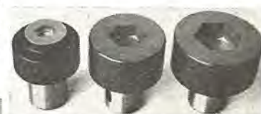
ボルト頭ヘッディング用ダイス (材質：焼入鋼)
