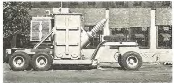
変圧器車 交流側 73.5-70-66.5-63-60 kV 入 21.2-20.2-19.2 kV △ 直流側 1,370 V 二重星形 容量 3,350 kVA 周波数 50/60 c/s Transformer on wheel.
