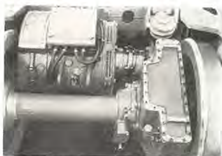
長野電鉄納台車に装備した狭軌用 WN ドライブ 主電動機および駆動装置 Traction motor and driving gearing.
