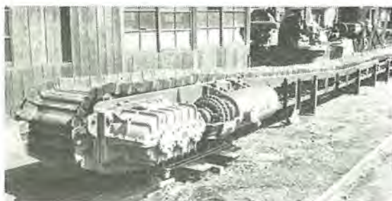
HDS-40 型 コンベヤ原動機(三菱 FPC 型フレキシブルパンコンベヤに取付けたもの)
