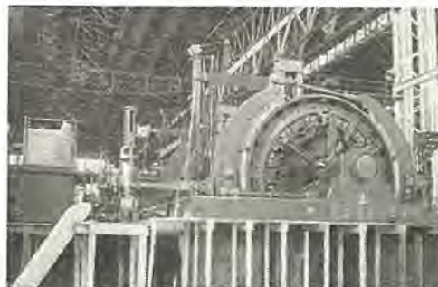
450 HP 複胴巻上機 450 HP Double drum hoist.
