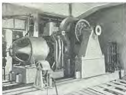
阪急百貨店納入貨用直流ギヤードエレベータ巻上機 3,500 kg, 75 m/min 60 HP D-C geared service elevator traction machine 3,500 kg, 75 m/min 60 HP for Hankyu dept. store in Osaka.
