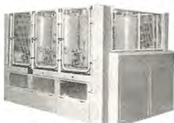
名古屋市交通局那古野変電所納 1,000 kW 600 V 6 タンク 重負荷 公称定格 風冷式密封型イグナイトロン整流器 Air cooled sealed type ignitron rectifier for the Nagoya Municipal Communication Bureau.
