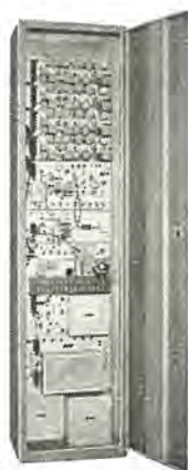
2,500 Mc 帯 AM-FM 多重無線通信装置 2,500 Mc AM-FM multiplex radio equipment.
