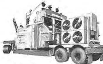
6 図 移動変圧器 20,000 kVA 132-67 kV/12.47 kV 重量 34 トン (米 W.H. 製)
