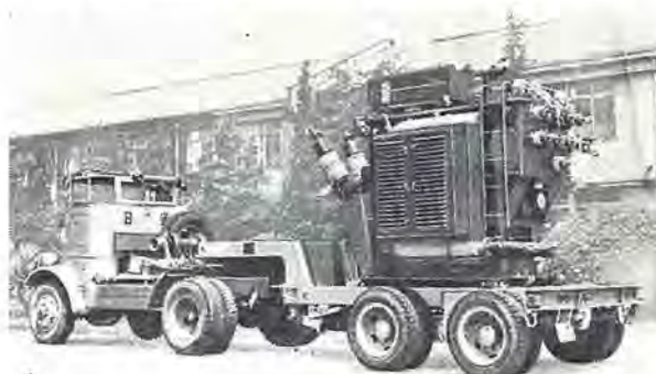
17 図 走行試験に出発する移動変圧器 変圧器は3図と同一 Fig. 17. Mobile transformer before travelling for test.
