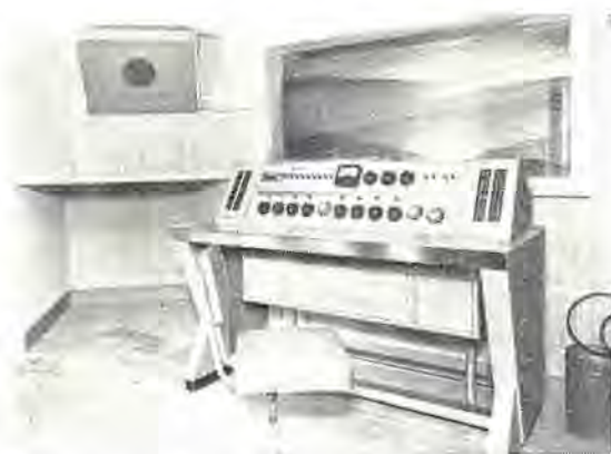
21 図 読売ホール放送中継用調整卓およびモニタスピーカ
