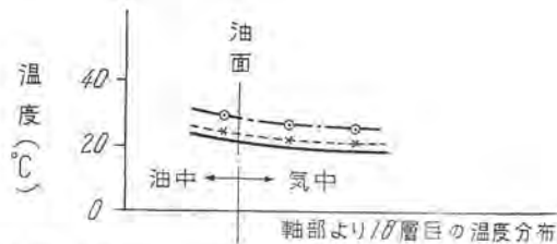
21 図 長時間耐圧前後の温度分布 (75°C 油中、外気 13°C)
