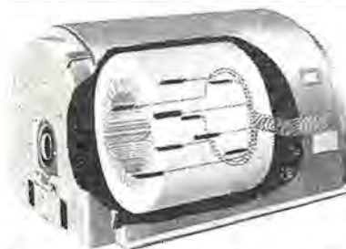
16 図 固定子コイル温度測定素子配置
