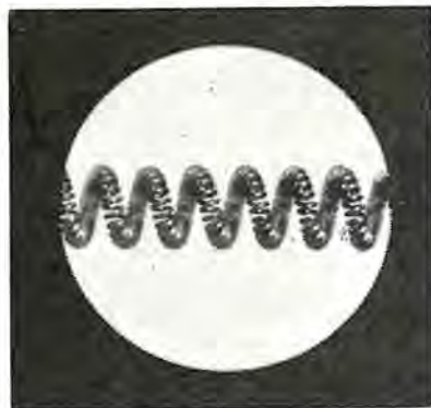
4 図 a 予熱起動型ランプのフィラメント (ダブルコイル)
