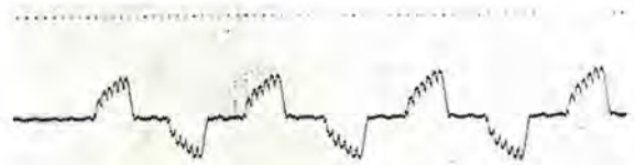
18 図 加熱時間=1 サイクル、 \alpha=0 の場合 Fig. 18. One full heat cycle current.
