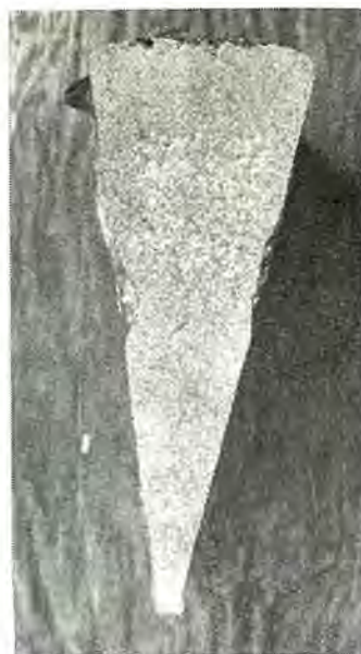
9 図 (a) 逆チル (肉眼) 組織 \times 70 Fig. 9 (a) Inverse chilled (micro) structure. \times 70
