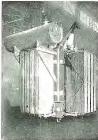
四国電力宇和島線連繫用 3φ 13,100 kVA 60 c/s 110/54.5 kV 3次 11,000 V 6,000 kVA 単巻変圧器
