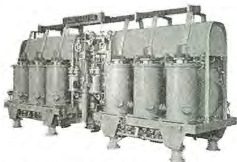
食塩電解用 水冷式ポンプ付イグナイトロン整流器 250 V 6,500 A 1,625 kW Ignitron rectifier.
