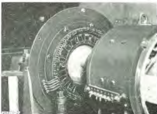
工場試験中の 175 VA 永久磁石発電機 110 V 3φ 60 c/s 360 rpm 20 P pf=1.0 Magneto generator.
