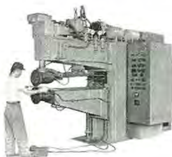
300 kVA 100,000 A 3 相低周波型スポット兼用シーム溶接機 Three phase low frequency type spot and seam welder.
