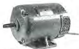
直流電動機 (I. B. M 機カード送り機械用) 1/2 HP 2 極 115 V 2,850 rpm 複巻 連続定格 D-C motor.
