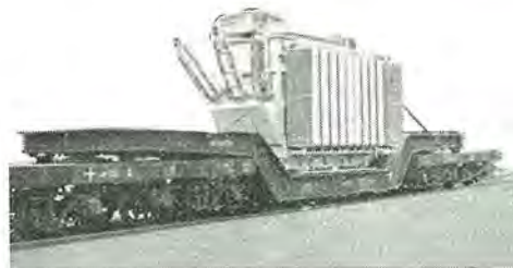
九州電力池田変電所納 3 相 6,000 kVA 60 c/s 66 kV/6,900—3,450 V ±10% URS 型負荷時タップ切替器付全装可搬式変圧器 Totally equipped portable transformer.
