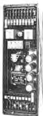
HKB-2 型継電器 Phase comparison relay.
