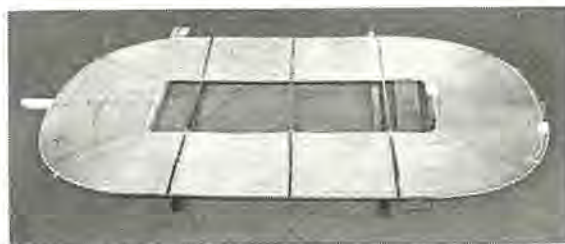
10図 外鉄型変圧器の1枚のコイル
