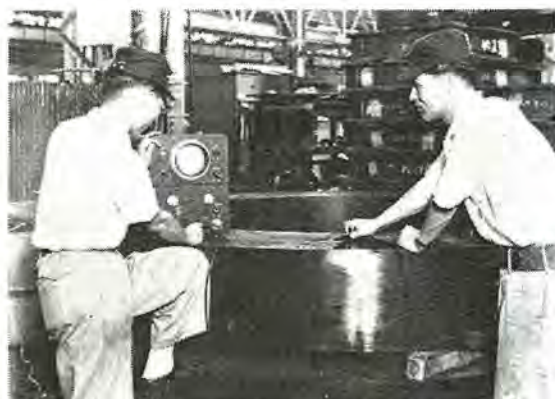
7 図 超音波探傷器で検査中のスパイダリム Fig. 7. Spider rim inspection by supper sonic inspector.
