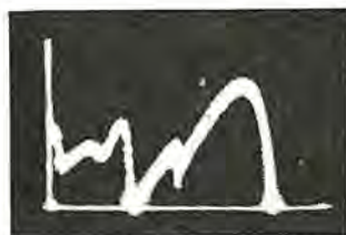
15図 巻線仕様 I 甚だしい非同期クロローリングを発生したもの
