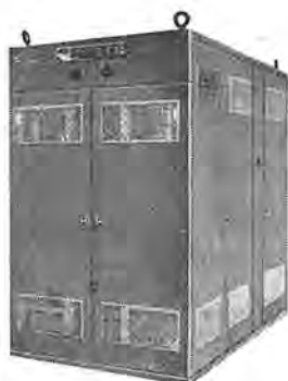
1,500 kW 600 V 2,500 A 12 タンク重負荷公称定格水冷式 密封型イグナイトロン整流器 キュービクル(1,500×2,500× 2,350) 全重量 3,250 kg
