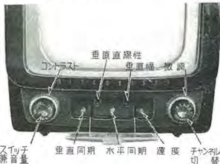
11図 14T-210 型前面調整箇所
