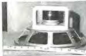
22 図 ウーファの磁気回路 (PW-120 型) Fig. 22. Magnetic circuit of woofer.
