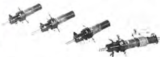
19 図 映像中間周波部コイル類 Fig. 19. IF coils.
