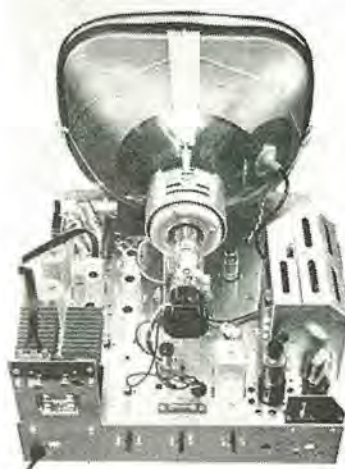
8図 シャーシ外観 (上面) Fig. 8. 14T-210 Chassis (Top view)
