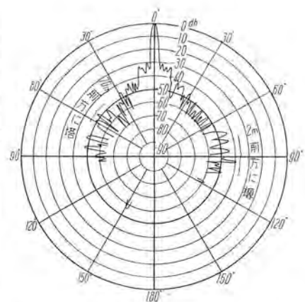
16 図 直線偏波パラボラ・アンテナの E 面内輻射特性
