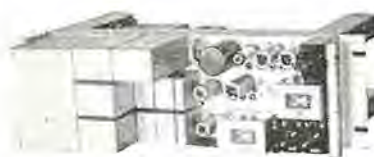
34 図 TM-R1型 遠隔測定受量器 Fig. 34. Type TM-R1 remote measurement receiver.
