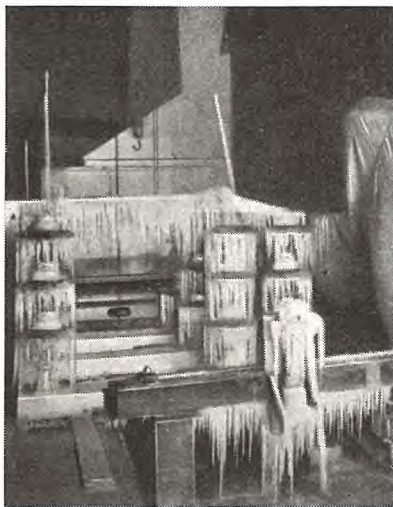
31 図 氷結試験中の V 型屋外用断路器 Fig. 31. V type outdoor disconnecting switch under frosting test.
