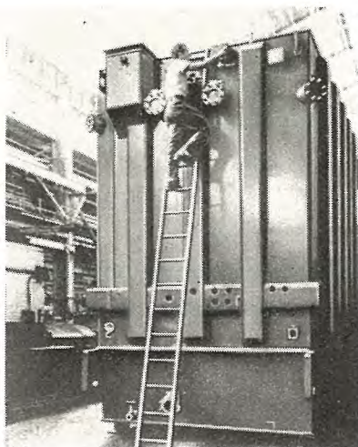
1 図 工場完成近い W 社製 315,000 kVA 変圧器
