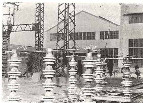
34 図 161 kV H 型屋外用断路器による 30,000 kVA 変圧器励磁電流遮断試験
