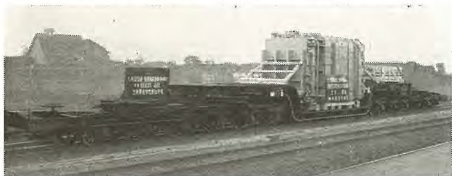
10 図 築上発電所用 65,000 kVA 変圧器組立輸送 (シキ 120 使用)
