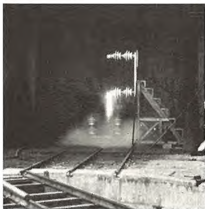
20 図 遮断試験中の 80.5 kV 1,500 MVA DBA 型電力ヒューズ Fig. 20. Type DBA 80.5 kV 1,500 MVA boric acid power fuse under interruption test.
