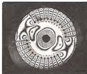
1 図 タービン発電機ロータ軸の遠心力による光弾性写真
