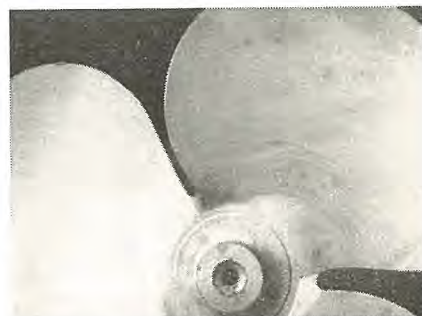
4図 扇風機プラスチック羽根の応力塗料による試験
