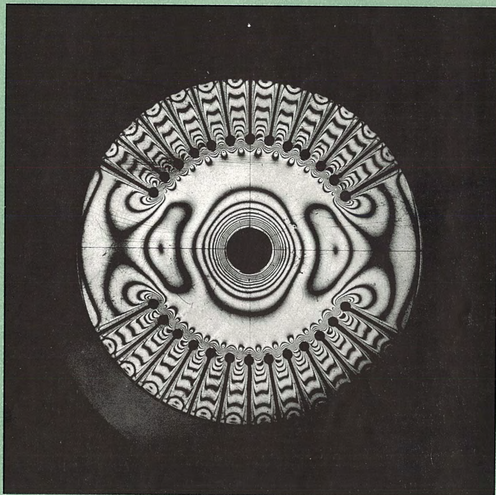
ターボロータの回転 のストレスを表わす 光弾性写真
