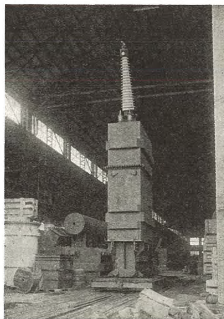
20 図 試験用上部タンクを使用して単相器として試験を受ける 93,000 kVA 変圧器
