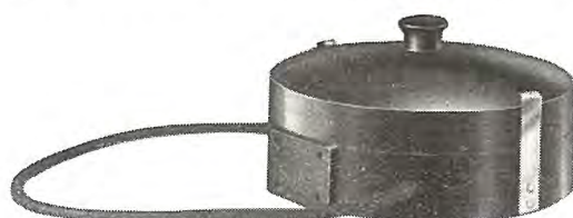
6 図 クライドノグラフ コンデンサ、ブッシングのタップに直接取付け て屋外で異常高電圧を簡単に測定できる。
