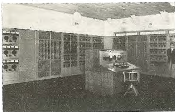
2 図 電気試験所に納入した交流計算盤 わが国最初の交流計算盤である。これと同種のものが、電力中央研究所に設置されることになっており、また当社研究所のものも最近活動を開始した。
