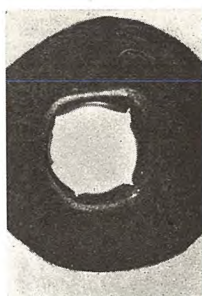
22 図 50 回目使用の撃針でつき破られた封板
