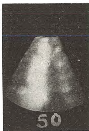
20 図 50 回使用後の撃針先端の拡大 (170 倍)
