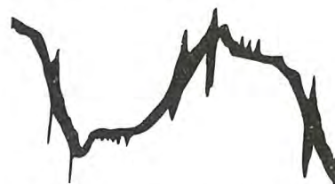
1 図 管端子間に現われた雑音電圧を増幅し 管電圧に重畳したオシロによる波形
