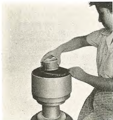
2 図 カゴ形回転子試験状況 Fig. 2. Squirrel cage rotor under test.
