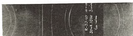
9-1 図 銅線の X 線回折写真試料銅線 30 mA, 35 kV 5 分露出
