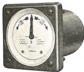
20 図 KI-24 型同期検定器 Fig. 20. Type KI-24 synchroscope.
