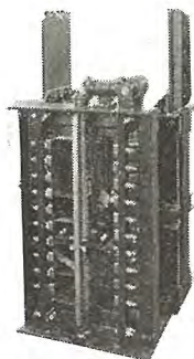
消弧リアクトル 152 kVA 22 kV/ \sqrt{3} 3-4-5-6-7-8-9-10-11-12 A 電動操作タップ切換式
