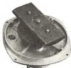
A.D.F. ループ空中線 A.D.F. set loop antenna.
