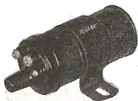
IC-JA 型点火コイル Ignition coil.
