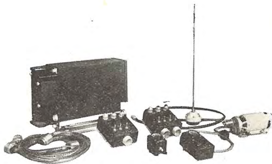
MAR-1 型小型航空機用無線機 MAR-1 Air borne miniature type communication set.
