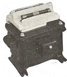
PN-15 型 3,300/110 V 15 VA 1.0 級計器用 変圧器
