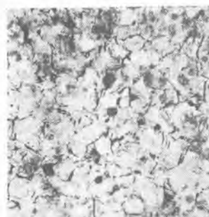
10 図 強靱鋳鉄顕微鏡写真 ×70 抗張力 抗折荷重 42.8 kg/mm 2 2,680 kg 撓み 硬度 6.9 mm 234 BHN Photomicrograph of tough cast iron.
