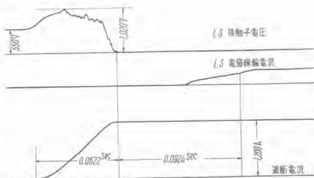
47 図 断流器遮断試験 Fig. 47. Arc rupturing test.
