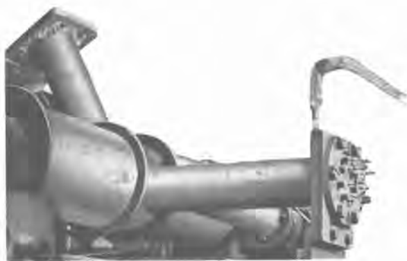
6 図 分析管と電磁石 Fig. 6. Mass spectrometer tube and magnet.
