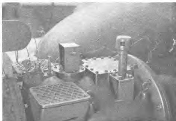
25 図 振動検出器をタービンに取付けた状態 Fig. 25. Vibration pickup fixed on casing.
