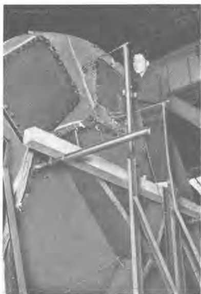
5 図 水圧試験による応力分布測定 (6,600 kW 3,600 回転機)
