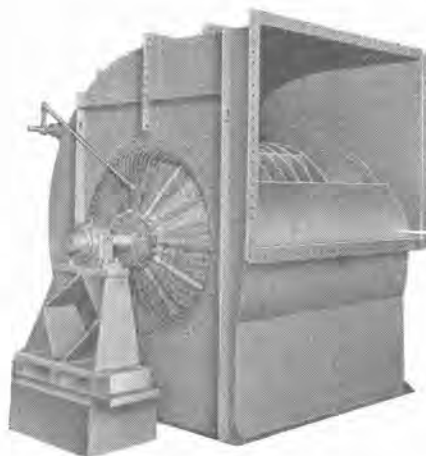
16 図 TV-105 強圧通風機 Fig. 16. Exterior view of the TV-105 turbovane fan.
