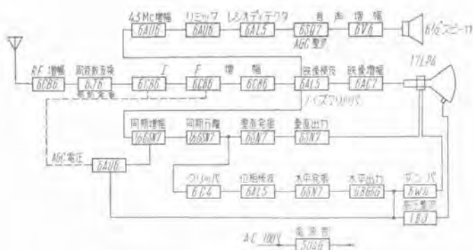
2. 図 101K 17 型受像機のブロックダイアグラム
