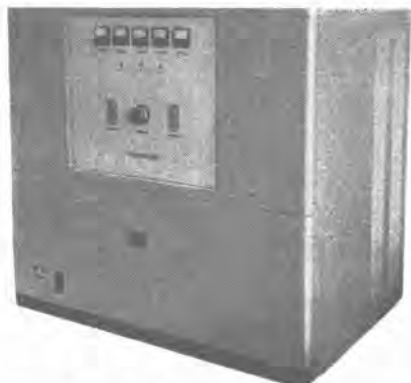
16 図 28 kW ラジオヒータ発振器 Fig. 16. Oscillator part of 28 kW radio heater.
