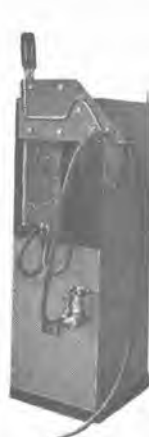
17 図 ラジオヒータ EH-3A 変流装置 Fig. 17. Current transformer of EH-3A radio heater.
