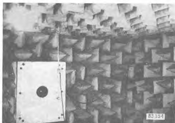
29 図 密閉箱と標準マイクロホン Fig. 29. Enclosure and standard microphone.
