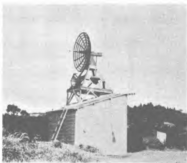
2 図 国鉄向 7,000 Mc 帯電波伝播試験用 拋物面鏡アンテナ
