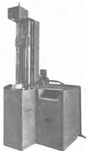
18 図 ラジオヒータ EH-3A 用トヨタカムシャフト焼入装置 Fig. 18. Cam shaft case hardening equipment of EH-3A type radio heater.
