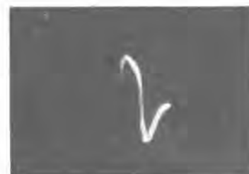
13 図 ブロッキングトランスの波形 Fig. 13. Wave form of blocking transformer.
