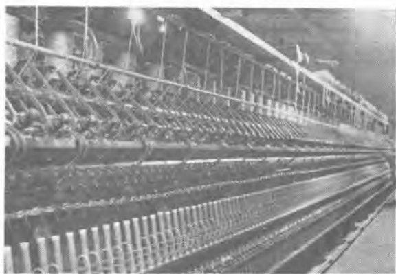
11 図 リング精紡機（紡毛） 光源が低すぎるためやムラが多い明るい部分に目は調応するから暗い部分がとくに見えにくくなる。
