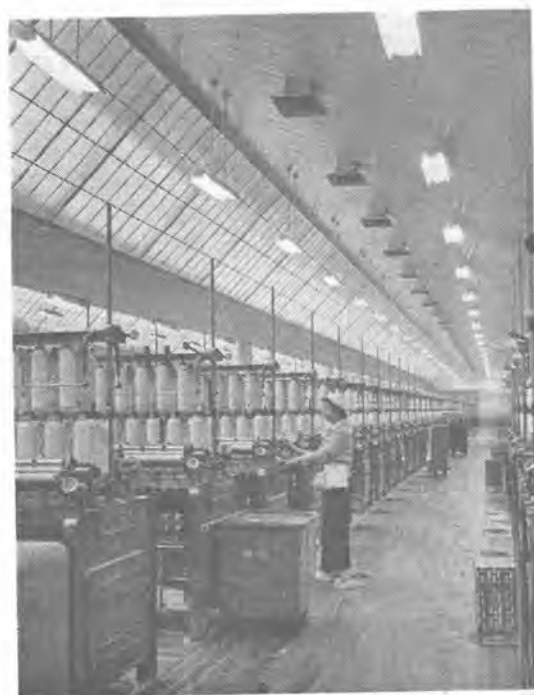
8 図 精紡機照明（天井が高いので均斉度はよい） Fig. 8. Lighting for spinning machines.
