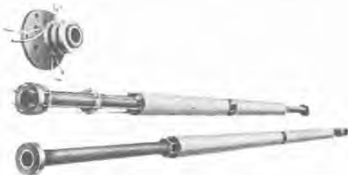
8図 ブラッシュローラ用ヒータ Fig. 8. Heater for a brush roller.
