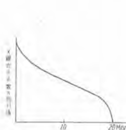
14 図 ベータトロンの X 線のエネルギー分布 Fig. 14. Energy spectrum of betatron X-ray.
