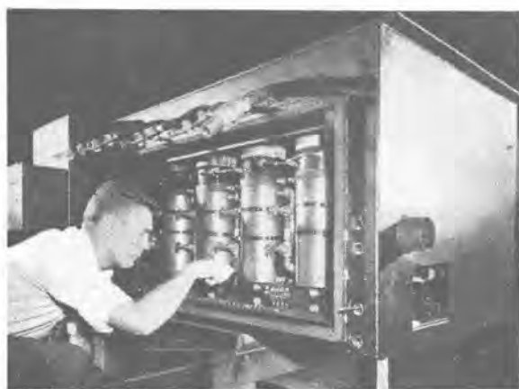
12 図 イグナイトロン電車用イグナイトロン装置 Fig. 12. Ignitron units of rectifier powered car.
