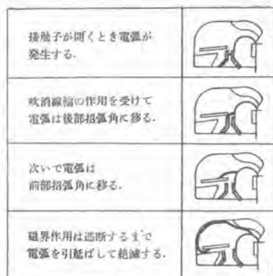
10 図 消弧の状況 Fig. 10. Quick-quenching arc.
