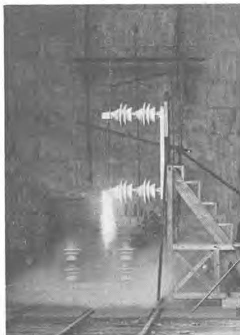
31 図 DBA-2 型 80.5 kV ヒューズ遮断光景 Fig. 31. Interruption of DBA-2 80.5 kV fuse.
