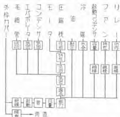
7 図 生産工程中の試験, 検査
