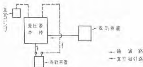
4 図 脱気注油中における変圧器本体よりの当社容器への採油
