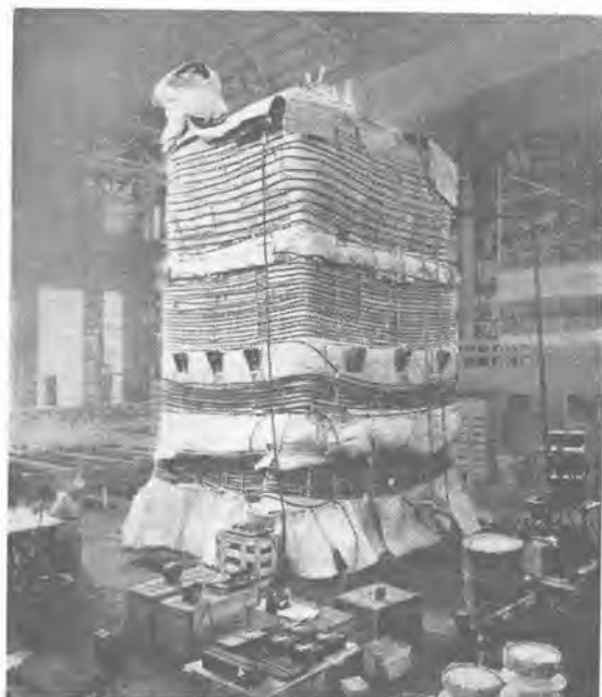
5 図 誘導加熱による外函加熱を利用して乾燥中の 72,500 kVA 変圧器
