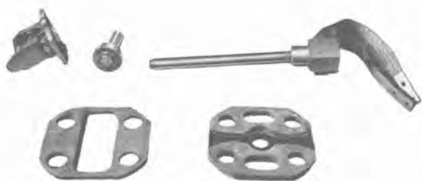
12 図 遮断試験後のコンタクトおよびファイバ Fig. 12. Contact and fibre after breaking tests.
