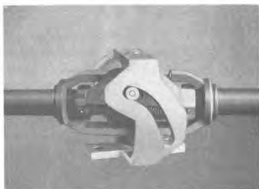
12 図 H 型断路器ブレード回転機構
