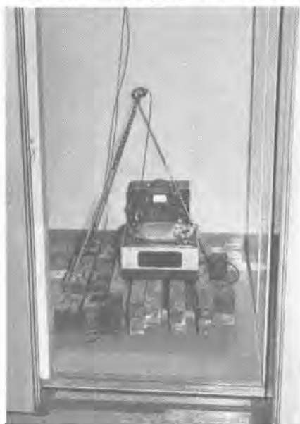
19 図 カゴ室内の騒音の録音 Fig. 19. Recording of noise in the cab.
