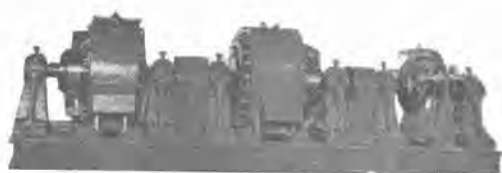
東海電機 KK 茅ヶ崎工場ブラシ試験機 14 kW - 17.5 kW 2,400-4,000 rpm D.C. motor generator for brush testing machine.
