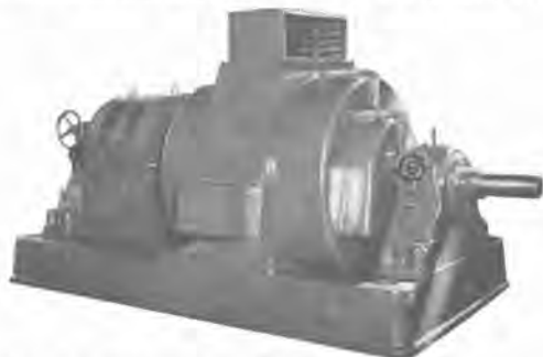
八幡納入(焼結工場)主排風機用誘導電動機 MS 閉鎖自己通風型 1,500 HP 6,600 V、60 c/s 1,800 rpm 4 極 B 種絶縁 1,500 HP induction motor for main exhaust fan.
