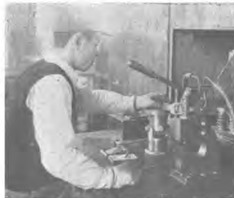
ラジオヒータパイットの鐵着 Brazing of bite by radio-heater.
