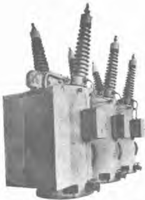
台湾電力天冷発電所納入 140-GM-500 型。 161 kV 800 A 油入遮断器 (遮断容量 5,000 MVA) Type 140 GM-500 oil circuit breaker 161 kV 800 A (Rupturing capacity 5,000 MVA)
