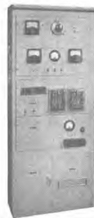
SB-II 型 水分率自動制御装置 Automatic control brimeter.
