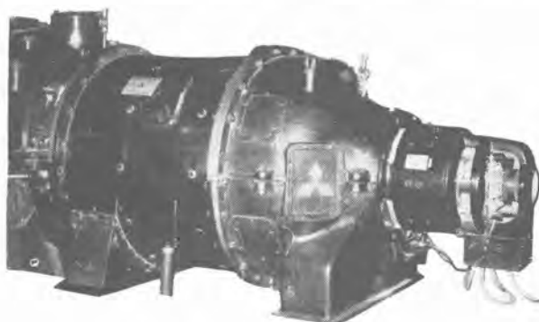
野沢石綿セメント株式会社 3,500 kW ユ式発電機 3,500 kW Ljungstrom turbine generator.
