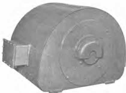
九州電力築上発電所納入 誘引通風機用 MK WB 型（屋外閉鎖自己通風型） 215 kW, 3,300 V, 60 c/s, 900 rpm, 8 P
