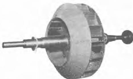
鶴見発電所納 TVID-1006 両吸込 ターボファンの扇車および軸 Wheel and shaft a assembly.
