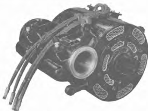
MB-320-AVR ジーゼル電気機関車用主電動機 定格 連続 130 kW 420 V 345 A 730 rpm 重量 2,020 kg “MB-320-AVR” traction motor for diesel electric locomotive. (130 kW)
