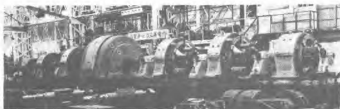
試験中の主電動発電機 (八幡戸畑鋼管用) 120 kW-200 kW-500 kW-650 kW-650 kW-300 kW-3,100 HP Synchronous motor D.C. generator for steel mill.
