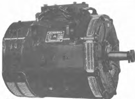
MB-1447-A 1 時間定格 100 HP 300 V 280 A 1,200 rpm (弱界磁) 重量 800 kg “MB-1447-A” traction motor for suburban car. (100 HP)
