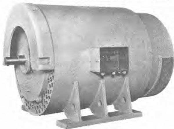
九州電力相ノ浦発電所納入誘引通風機用 MK WFT 型 (屋外銅冷却管付外扇型) 230kW、3,300V、60c/s、900rpm、8P
