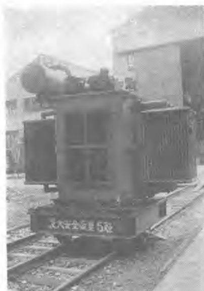
UR 型負荷時電圧調整器 450 kVA 3φ 50 c/s 3,450 V±10/5% 線路容量 45,000 kVA/9,000 kVA Type "UR" load ratio tap changer 450 kVA, 3φ, 50 c/s, 3,450 V±10/5% line capacity 45,000/9,000 kVA.
