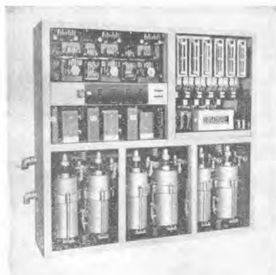
26 図 W 社製イグナイトロン機関車のイグナイトロン装置。下方に 6 箇の円筒形のイグナイトロンが見える。イグナイトロン 2 箇で 500 H. P. の電動機 1 箇ずつに供电する。
