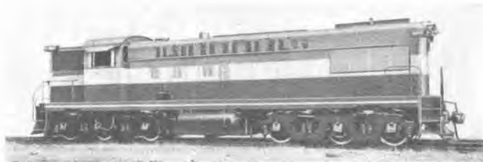
15 図 147 t, 6 軸, 万能, 1,600 H.P. ジーゼル電気機関車, W 社およびボールドウィン社製
