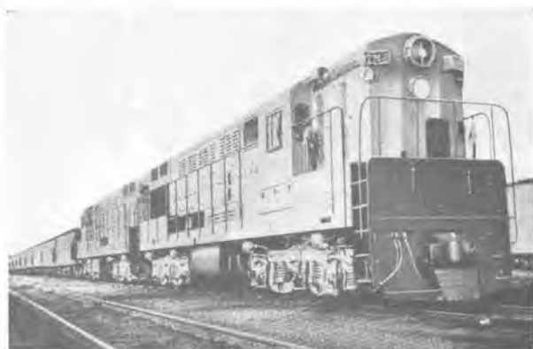
13 図 最新鋭のジーゼル電気機関車 トレインマスター, シングルエンジンの 2,400 H.P. 6 軸, 170 t, 万能, ダイナミックブレーキ。列車暖房用ボイラー 付, W 社およびフェアバンクスモース社製, 1 基で 2,400 H.P. の大馬力が最大の特長。
