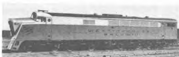
19 図 W 社製の 4,000 H. P. 224 t ガスタービン電気機関車 Fig. 19. 4,000 H. P. gas-turbine electric locomotive.
