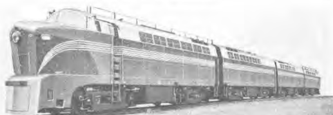
14 図 112 t, 4 軸, 貨車用 1,600 H.P. ジーゼル電気機関車。写真は4両重連して6,400 H.P. となっている。W 社およびボールドウィン社製。
