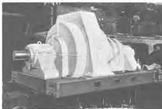
1 図 日亜製鋼 3,000 HP 3,300 V 60~10 P 720 rpm 閉鎖他力通風型誘導電動機
