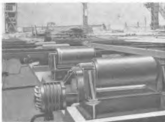
7図 使用実例 Fig. 7. Actual example of installation of motor roller.
