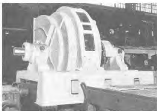
2 図 徳山鉄板 No. 2. 1,500 HP 3,300 V 60~ 28 P 閉鎖他力通風型誘導電動機
