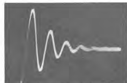
送出高周波パルス 250 Kc (高千穂白相送信 尖頭値 1250 V) H. F. Pulse sent out at Takachiho white-phase, peak value 1250 V.
