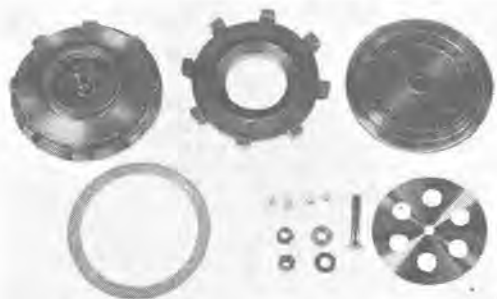
10 図 吸入弁 吐出弁 シリンダヘッド組立 Fig. 10. Suction valve, discharge valve and cylinder head assembly.
