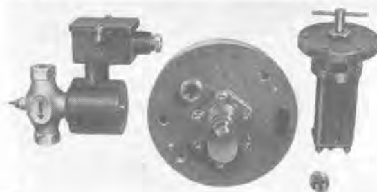
11 図 オイルポンプ オイルフィルタ ソレノイドバルブ Fig. 11. Oil pump, oil filter and solenoid valve.
