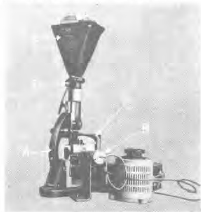
10 図 円板前面および端面の 振動観測装置 Fig. 10. Apparatus for observing vibrating motion at the edge of disc.
