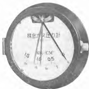
10 図 機械式ガス圧力計 Fig. 10. Gas pressure indicator with alarms.
