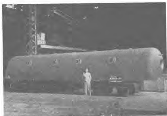
6 図 完成したる蒸汽ドラム Fig. 6. Boiler drum completed.
