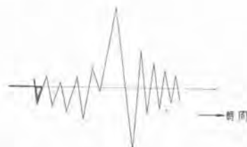
14 図 回転子導体断線のオシロ波形 (13 図の微分波形)
