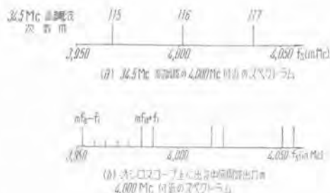
2 図 34.5 Mc の高調波およびオシロスコープ上に現われる中間周波出力スペクトラム
