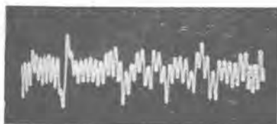
23 図 不良 Al ダイキャストロータ
