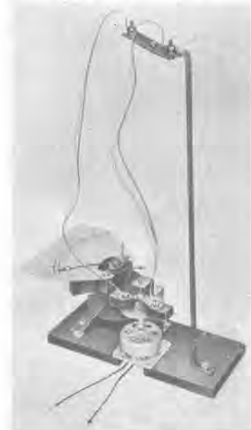
2図 トルク測定装置 Fig. 2. Torque measurement equipment.
