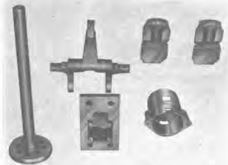
13 図 遮断試験後のコンタクトの状況 Fig. 13. Wearing condition of the contact when inspected.
