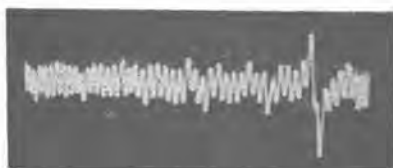
22 図 とくに1個所不良個所を有する Al ダイキャストロータ
