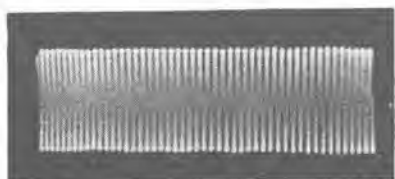
15 図 ヒズミのない Al ダイキャスト回転子 Fig. 15. Al die-cast rotor without excentricity of center.
