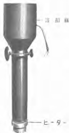
2 図 風冷式水銀蒸気ポンプ Fig. 2. Air cooled mercury vacuum pump.
