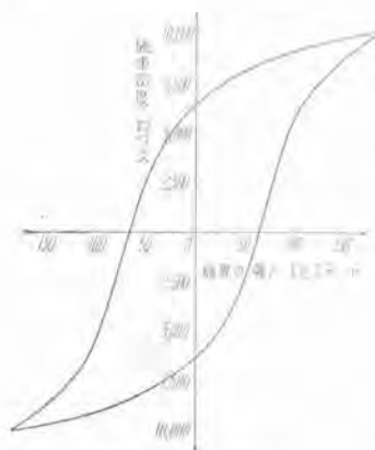
13 図 熱処理炭素鋼板履歴曲線 Fig. 13. Hysteresis loop of heat treated carbon steel.
