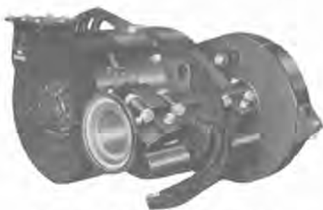
15 図 MB-320-AR 形主電動機 420 V 73:16 (4.56) 歯数比 960 mm 車輪径試験記録による Fig. 15. Type MB-320-AR traction motor.
