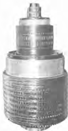
13 図 発電機電機子 (ファン未取付) Fig. 13 Main and auxiliary generator armature.
