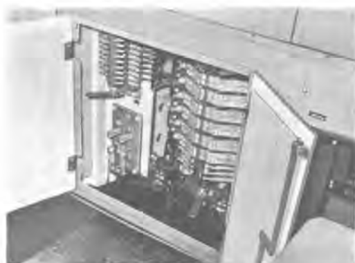
23 図 制御機器室下部 Fig. 23. Control panel (reverser, control cut-out switch and etc.).
