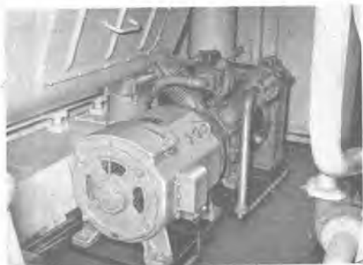
19 図 電動空気圧縮機 Fig. 19. Type MC-2 motor-driven air compressor.
