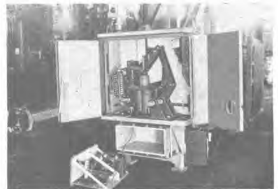
(b) キャパシタトリップ装置を引出した所 (b) Capacitor trip apparatus taken out.
