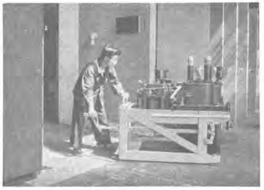
20 図 WB 型用台車(床上の O.C.B. を吊上げて居る所) Fig. 20. Type. WB transfer truck.
