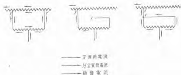
12 図 タップ変換動作説明図
