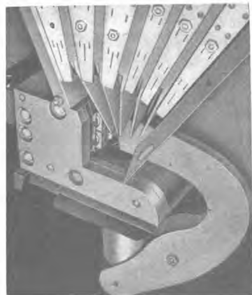
4 図 消弧室コンタクトおよび噴気孔部 Fig. 4. Contacts and air nozzle
