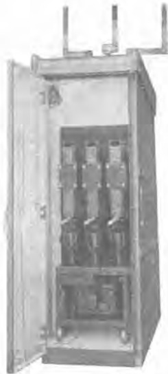
14 湿度 95% の屋外用メタルクラッドに収用して遮断試験中の 3-DH-10 型磁気遮断器
