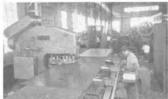
25 図 ターレットパンチングプレス(高能率孔明機械) Fig. 25. Station punch press.
