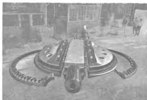
12 図 入口弁弁体 Fig. 12. Valve body of inlet valve.
