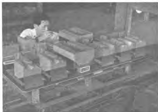
1 図 鑄 物 砂 型 Fig. 1. Foundry core.
