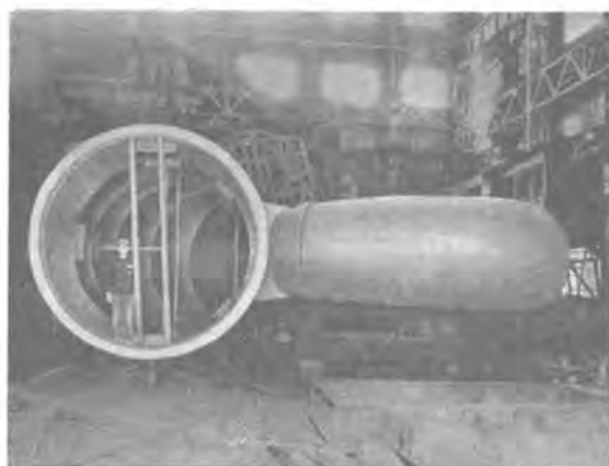
9 図 スパイラルケーシング工場組立 Fig. 9. Factory assembling of spiral casing.
