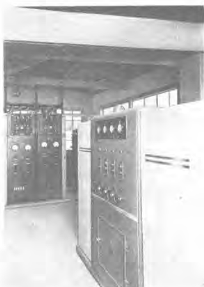
5 図 DH-3 型 (20kW) ラジオヒータ Fig. 5. Type DH-3 (20kW) Radio Heater.
