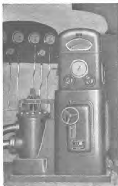
13 図 調速機アクチュエーター Fig. 13. Actuator of speed governor.
