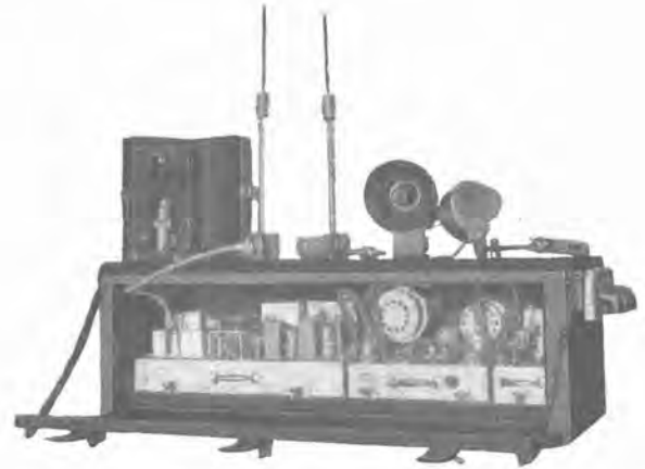
5 図 FR-1 型 150 Mc/FM 無線機 国鉄操車場送受信機部、電源部および選択呼出部
