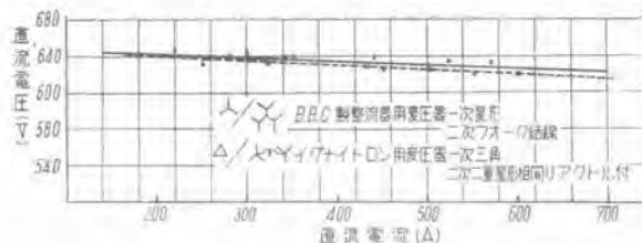
16 図 西ノ京変電所イグナイトロンと BBC 製多陽極型整流器並列運転 (実線イグナイトロン, 点線 BBC 製整流器)
