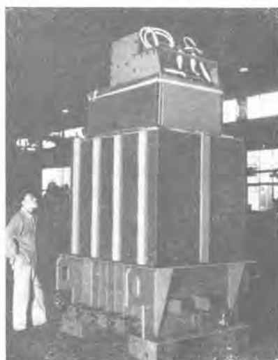
5 図 単相 10,000kVA フォームフィット 変圧器中身
