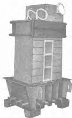
4 図 鉄心積み前の単相 10,000kVA フォームフィット変圧器
