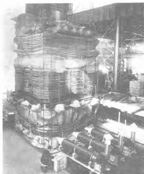
10 図 乾燥中の 117,000kVA 変圧器 (誘導加熱によるタンク加熱と誘導加熱を利用した熱風乾燥併用)
