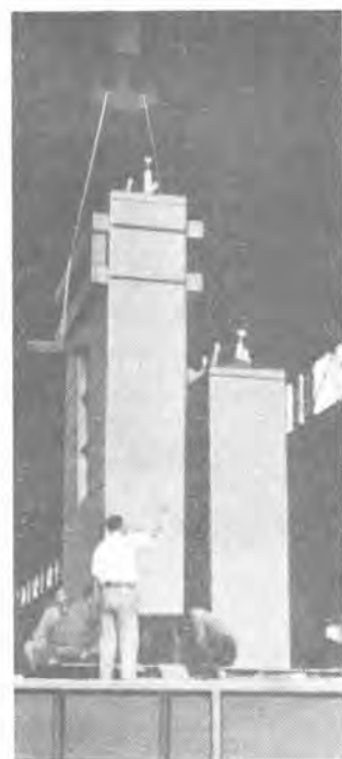
9 図 117,000 変圧器の コイル立て作業
